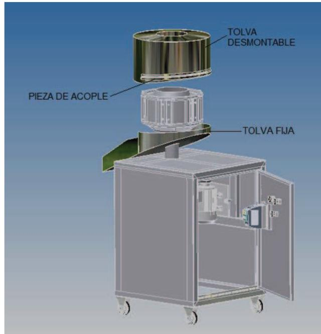
**Figura 5.17** Ensamble completo de la máquina rebanadora
