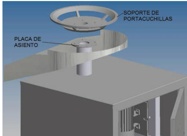
**Figura 5.4** Montaje del soporte de porta-cuchillas en la estructura
