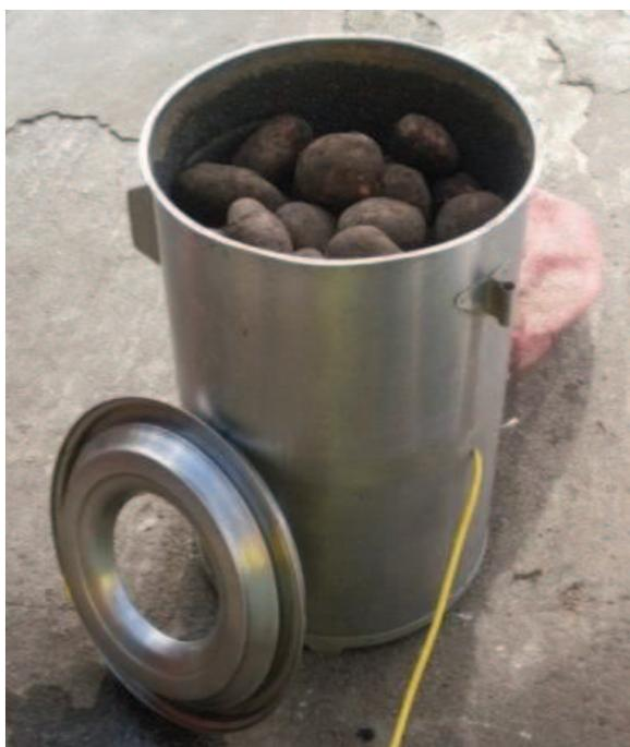
**Figura 2.1** Máquina peladora de papas
