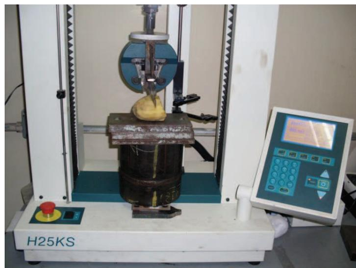
**Figura 3.1** Máquina de ensayo Tinius Olsen del laboratorio de materiales de la Facultad de Ingeniería Mecánica
