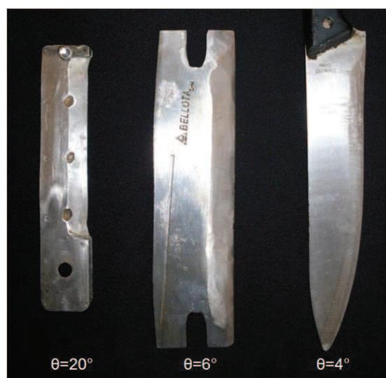
**Figura 3.2** Cuchillas planas en acero inoxidable con diferente ángulo de corte
