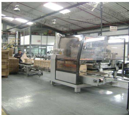
Fig. 3.23.- Armado de Cajas y Encajonado
