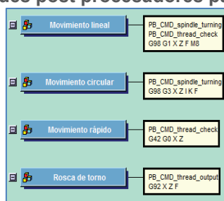
Figura No. 21 Programación bloques post procesadores para “Trayectoria para Herramienta”
