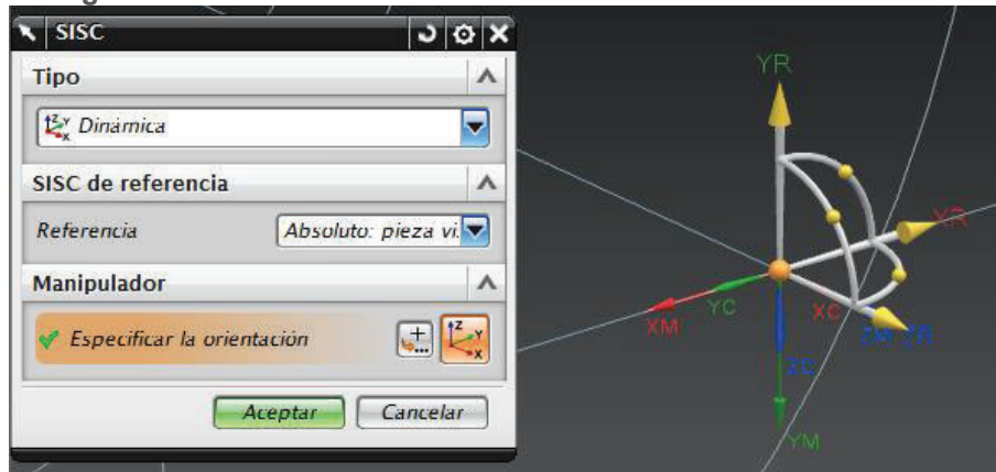
Figura No. 33 Posición del sistema de coordenadas de referencia
