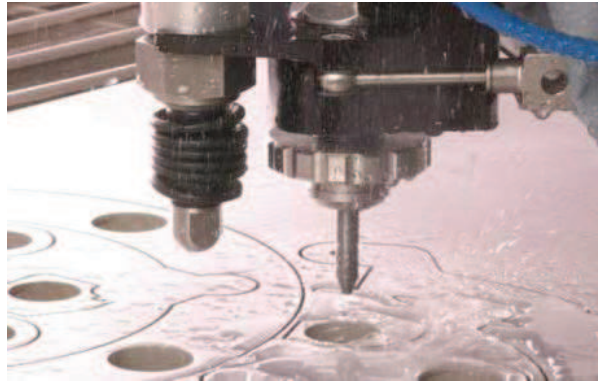
Figura 5.5: Corte por flujo de agua 100
