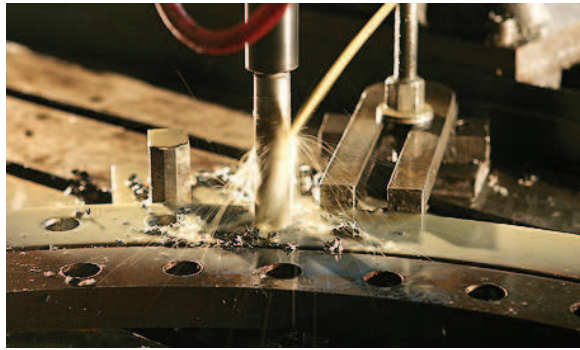
Figura 5.4: Corte por arranque de viruta 99
