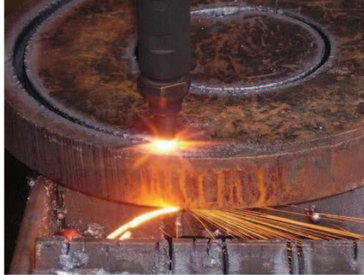
Figura 5.2: Oxyfuel gas cutting (Oxicorte) 96
