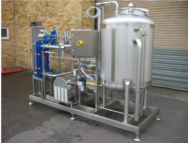
Figura 7 Unidad de limpieza de un solo tanque para uso en farmacéutica sin recuperación de químicos (Fuente: www.niroinc.com )
