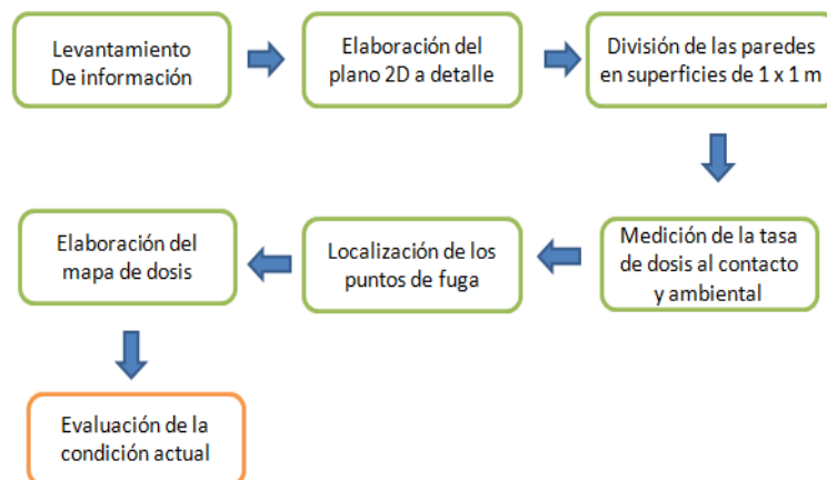
Figura 2.1. Diagrama de flujo utilizado para la evaluación de la condición actual del blindaje de la cámara de irradiación
