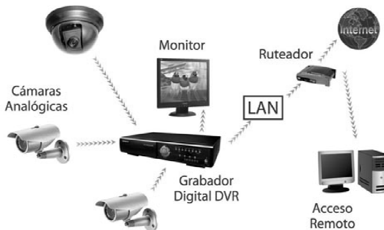
Figura 1.5 Sistema CCTV digital 1
