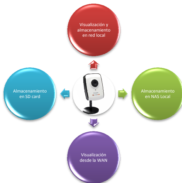
Figura 1.36 : Flujo de Información de una Cámara IP
