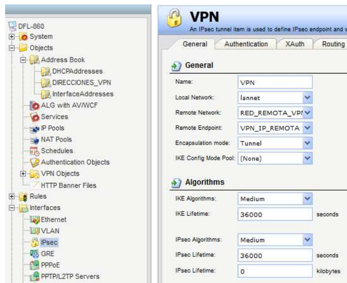
Figura 3.22 Creación de Túnel IPsec Parte 1
