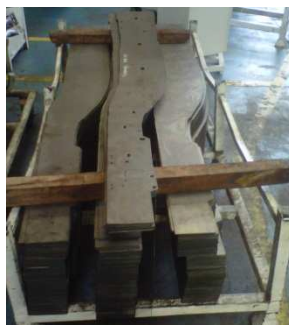
Figura 2.11. Desarrollo de Rieles Delanteras Internas.
