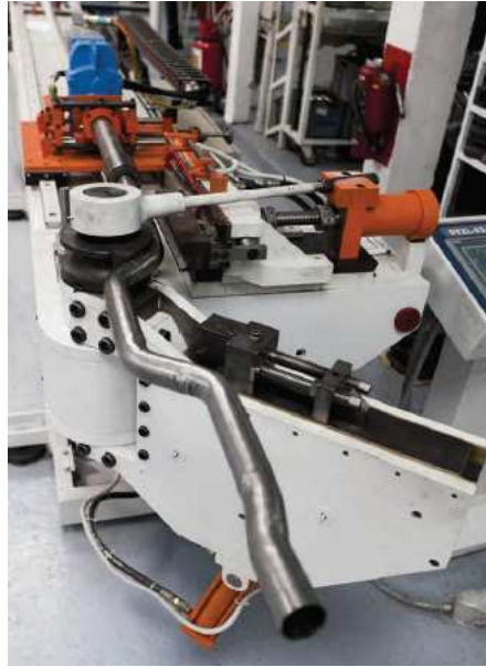
Figura 2.31. Maquina CNC doblando Tubo Barra de Tablero.
