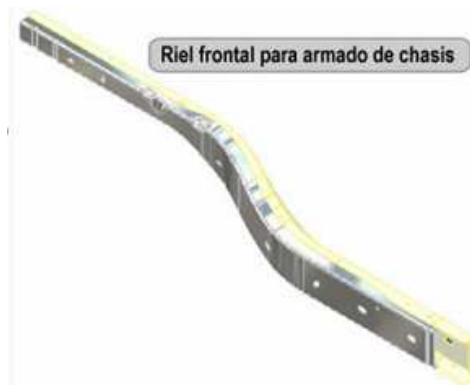
Figura 2.10. Riel frontal para armado de chasis.
