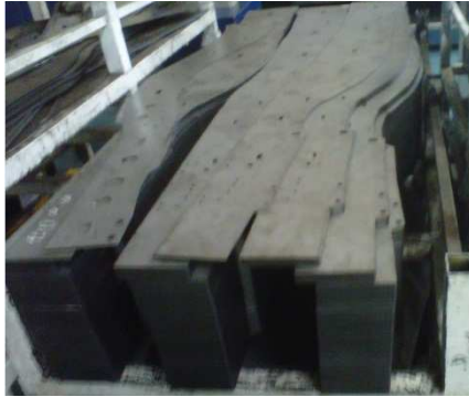
Figura 2.12. Desarrollo de Rieles Delanteras Externas.
