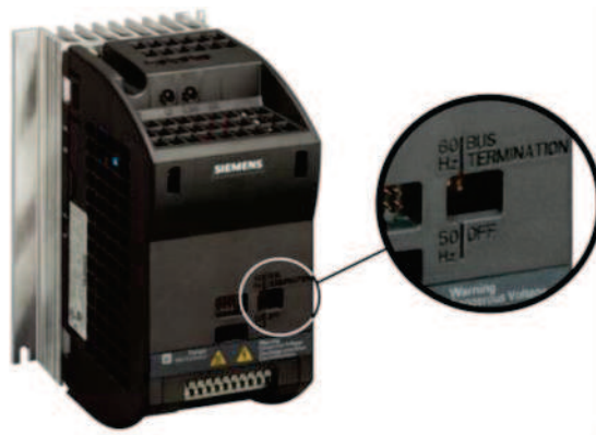
Figura 3.13. Modificación de la frecuencia de alimentación del variador de 50hz a 60hz
