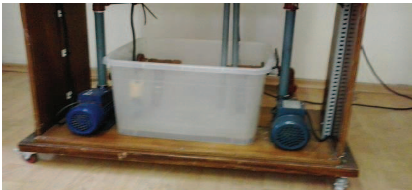
Figura 3.2. Bombas centrífugas y tanque principal
