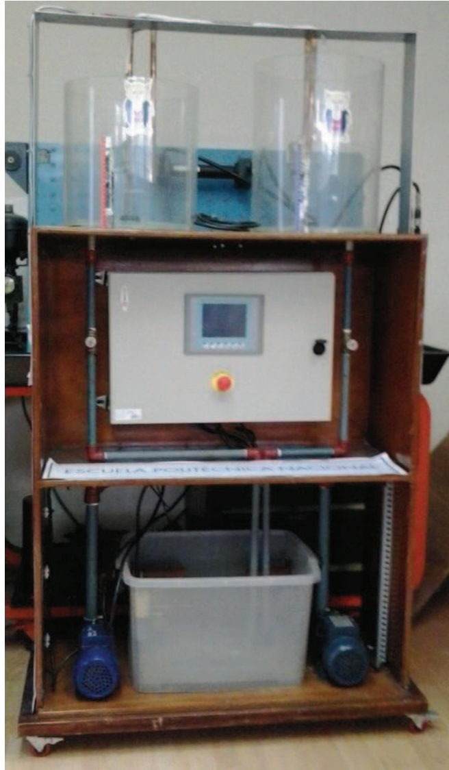
Figura 3.1 Módulo de control de nivel, izquierda para control PID, derecha para control difuso
