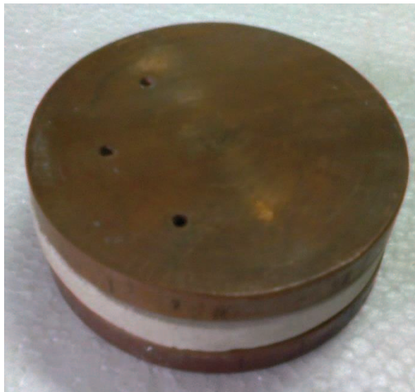
Figura 4.12: Placa caliente-muestra-placa fría
