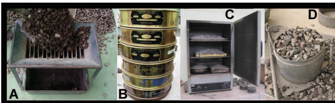
**Foto 20** - Cuarteado agregados, serie de tamices, horno de secado y agregados en briketa
