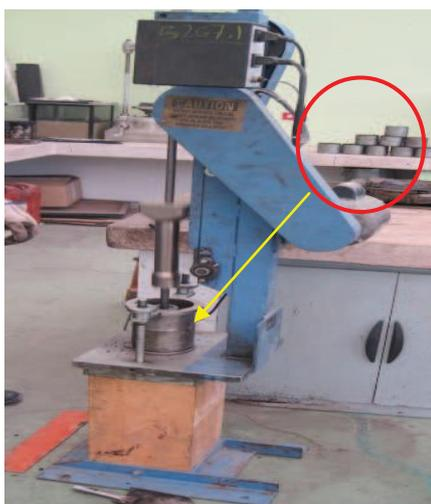
**Foto 22** - Ensayo martillo Marshall a briquetas
