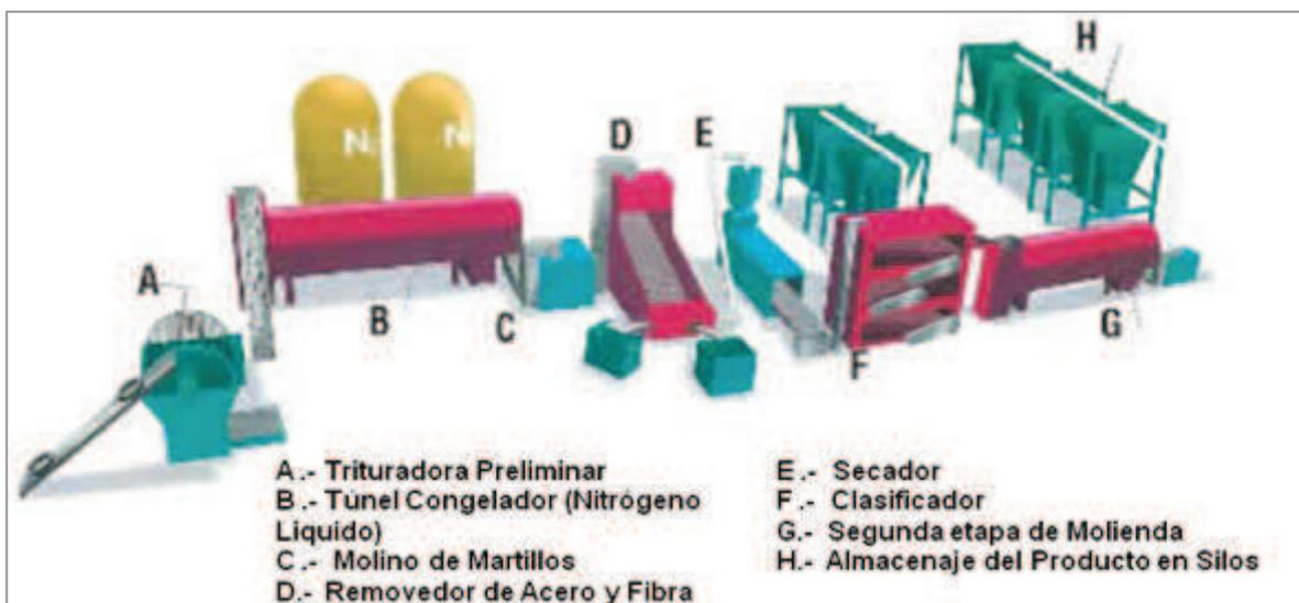
**Figura 14** - Esquema de Planta de Trituración Criogénica de Neumáticos.
