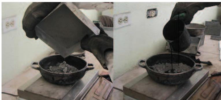
**Foto 21** - Mezcla agregados y asfalto para elaboración de briquetas
