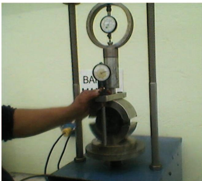
**Foto 24** - Briqueta Marshall ensayo estabilidad y flujo
