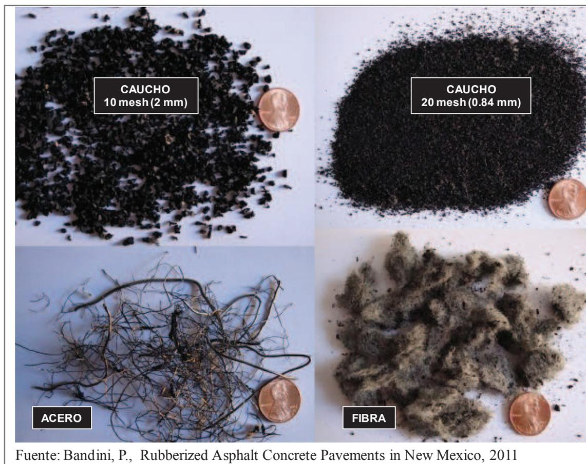
**Foto 15** - Productos finales del proceso (Partículas de Caucho, Acero y Fibra Textil)
