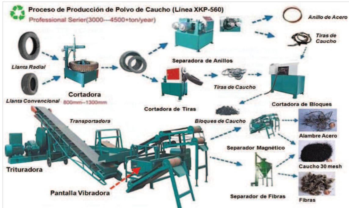
**Figura 32** - Proceso de Trituración Mecánica de llantas para obtener partículas de caucho
