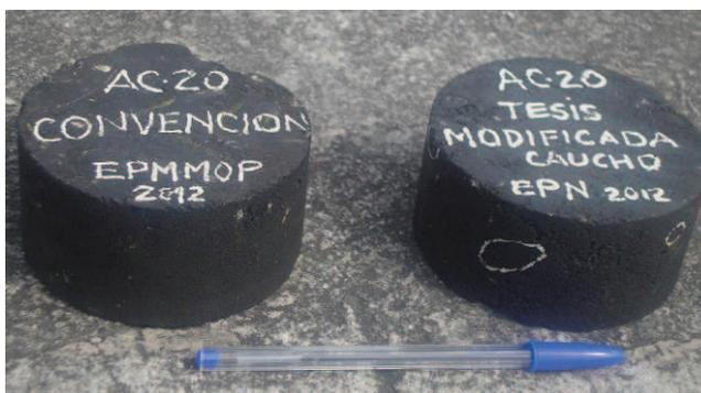
**Foto 23** - Briquetas Marshall convencional y modificada
