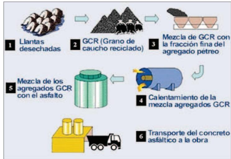
**Figura 19** - Diagrama de Aplicación Gránulos de Caucho por Vía Seca
