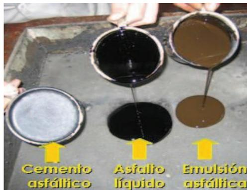
**Foto 9** - Tipos de asfaltos para pavimentación
