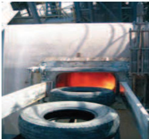
**Foto 5** - Llantas desechadas como combustible en horno de cemento
