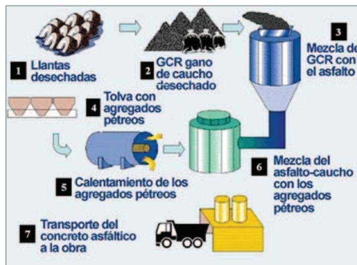
**Figura 20** - Diagrama de Aplicación Gránulos de Caucho por Vía Húmeda
