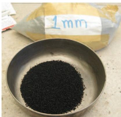
**Foto 19** - Partículas de caucho utilizado en los ensayos de laboratorio
