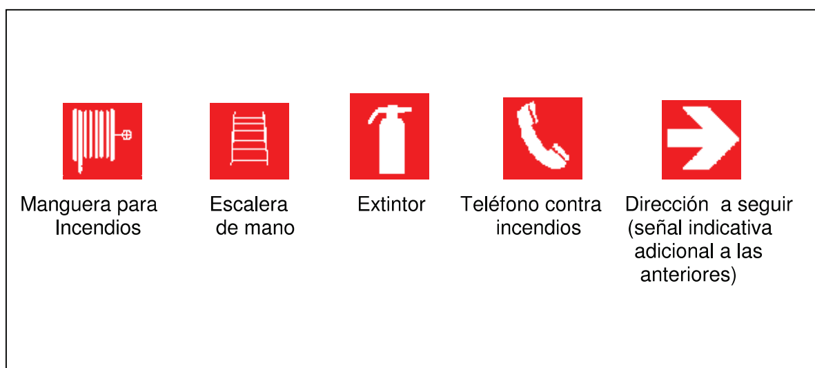
Figura 2.12 - Señalética de lucha contra incendios
