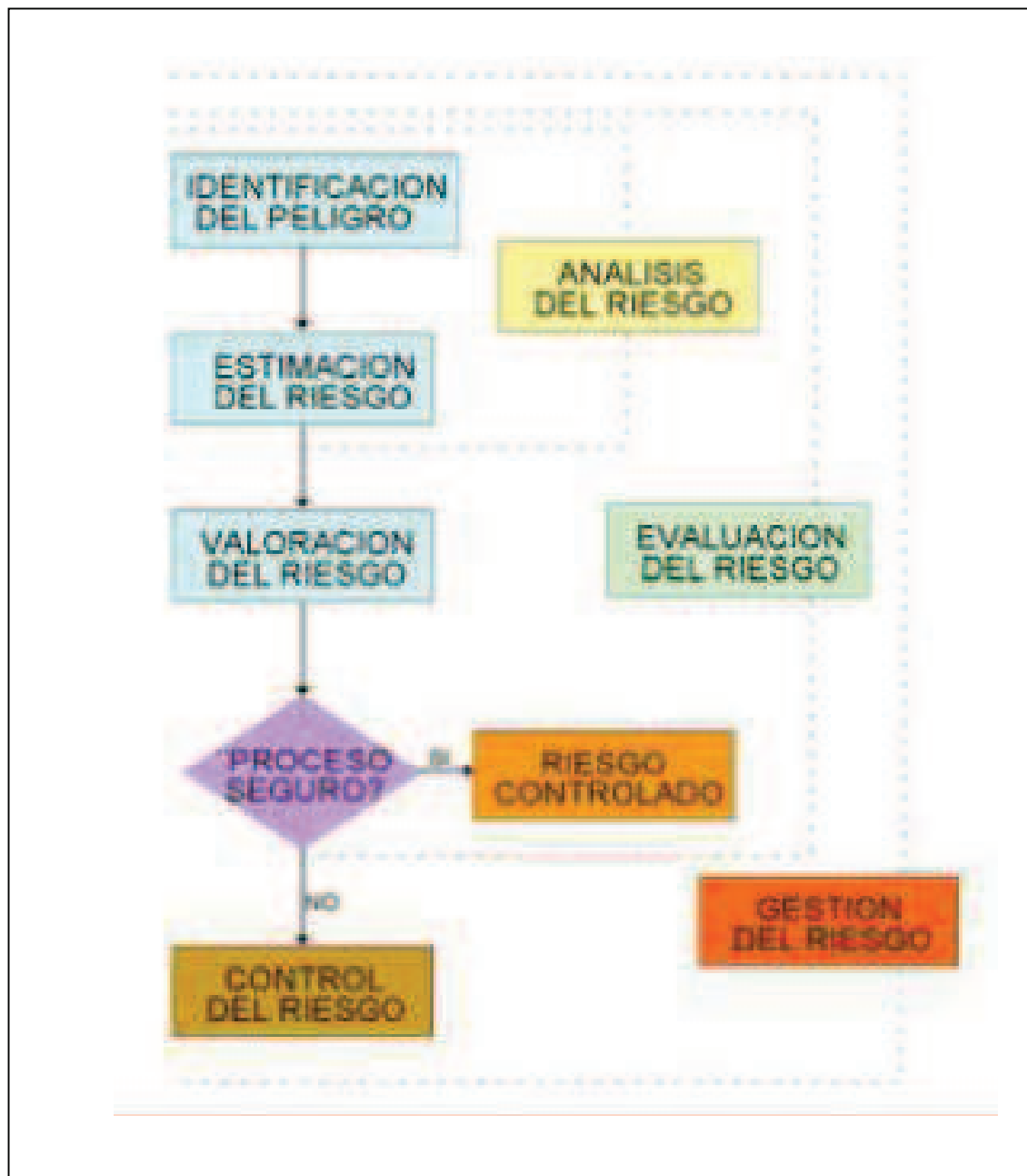
Figura 2.6 - Proceso iterativo para la gestión del riesgo
