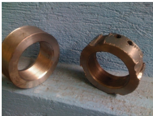
Figura AVI.2. Fotografía antes y después de la reparación de la tuerca de sujeción.
