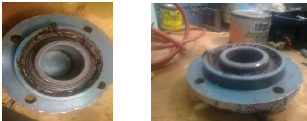
Figura AVI.3. Fotografías antes y después del cambio de rodamientos del molino.
