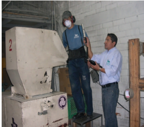
Figura 2.7. Medición de concentración de polvo en el área interna de los molinos
