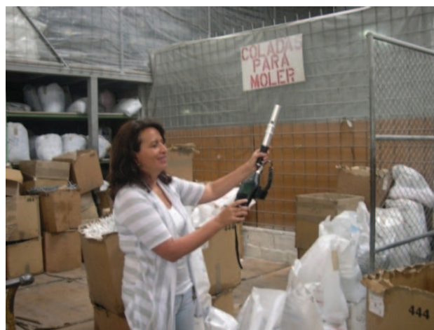
Figura 2.8 Medición de polvo en el área externa de los molinos
