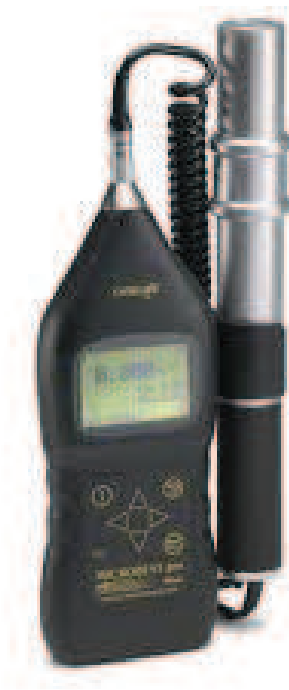
Figura 2.6. Microdust-pro, medidor de concentración de partículas
