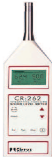
Figura 2.4. Sonómetro Cirrus modelo CR 260, tipo 2 (Cirrus research plc, (2009), p.1, 3)
