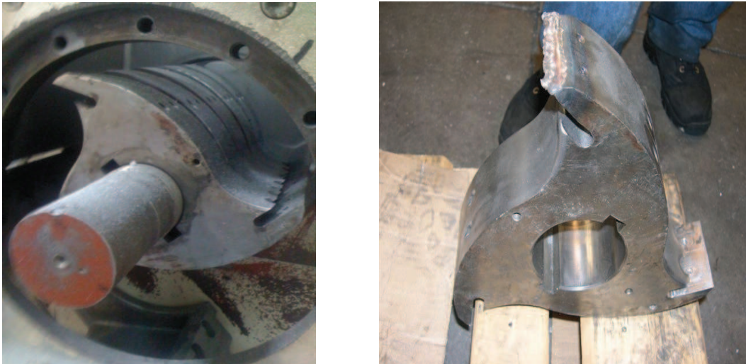
Figura 3.17. Fotografías de cuchillas móviles antes de ser afiladas al ángulo de 45^\circ
