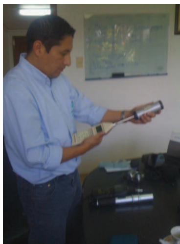
Figura 2.5. Calibración del sonómetro CR 260, tipo 2
