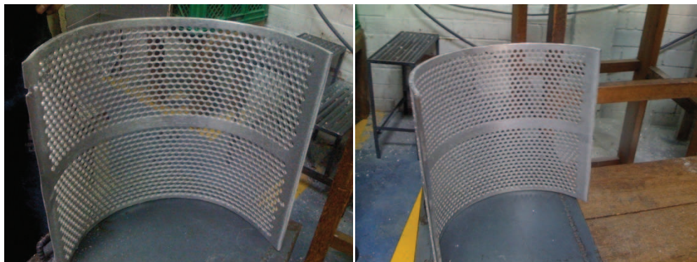
Figura AVI.1. Fotografías antes y después de la reparación de la criba o malla
