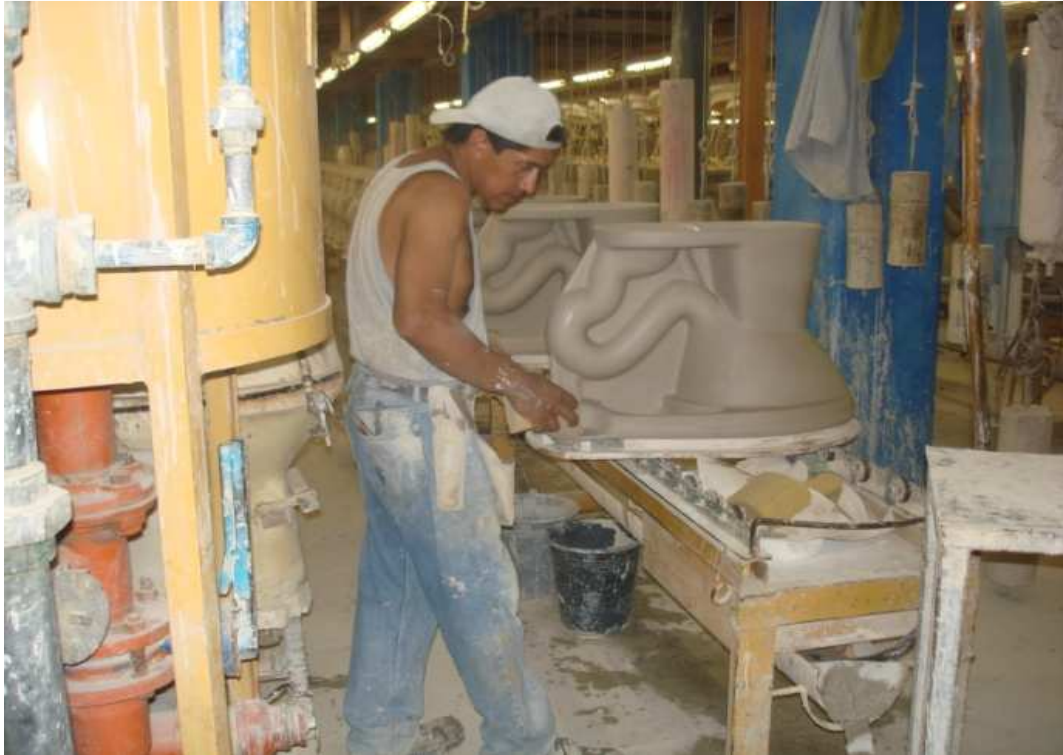
Figura 3.11. Fotografía que muestra una escena de las tareas de acabado exterior de las pocetas (EDESA, 2011)
