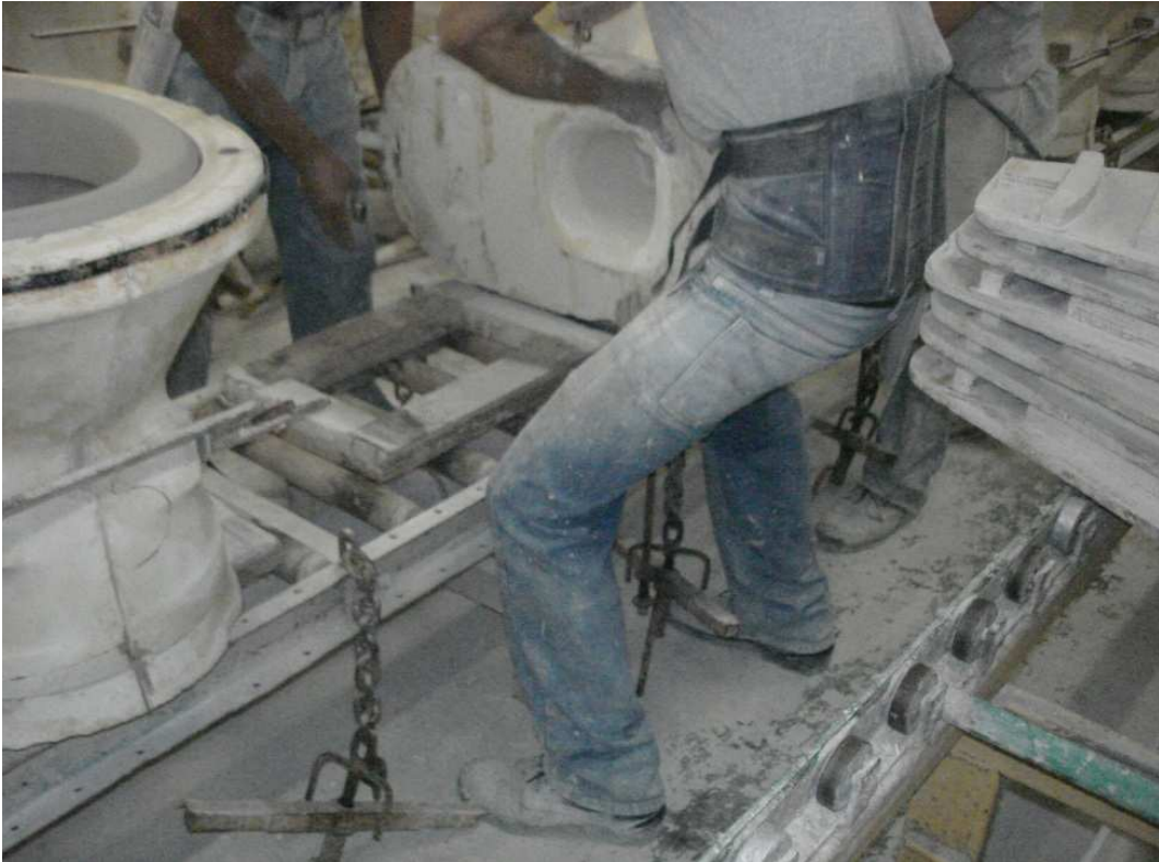
Figura 3.10. Fotografía que muestra una escena de la tarea de desconchado (EDESA, 2011)
