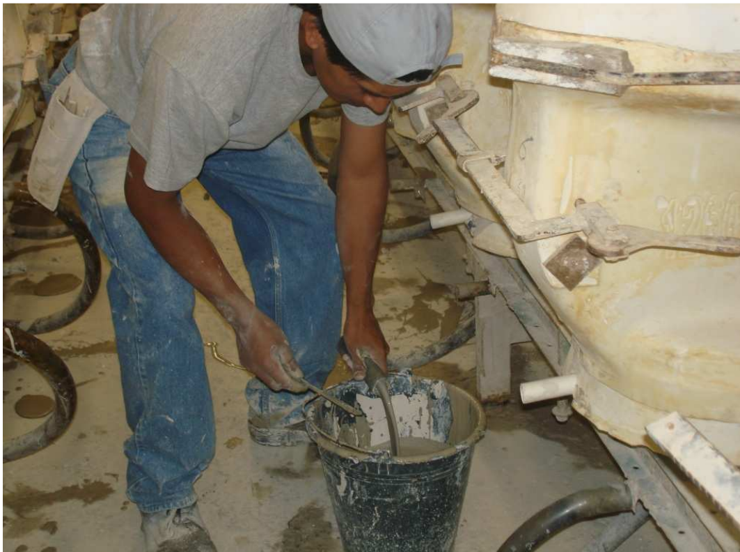
Figura 3.6. Fotografía que muestra el sistema de alimentación de pasta a los moldes (EDESA, 2011)
