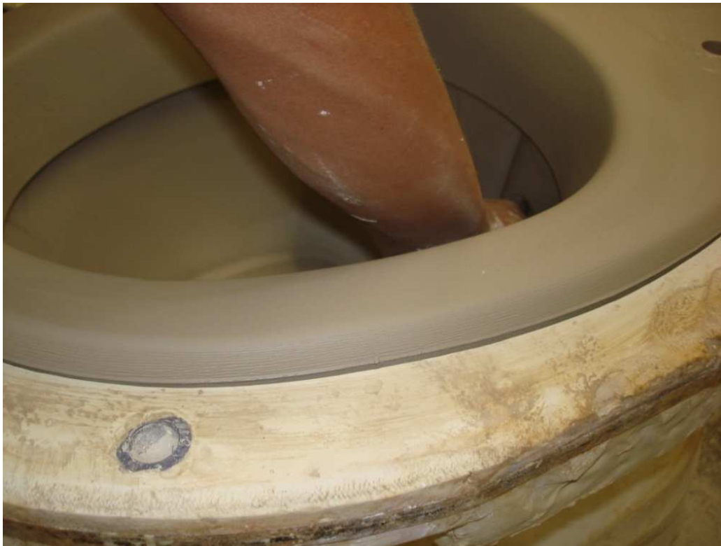
Figura 3.7. Fotografía que muestra una escena de la tarea de taponado de pocetas (EDESA, 2011)
