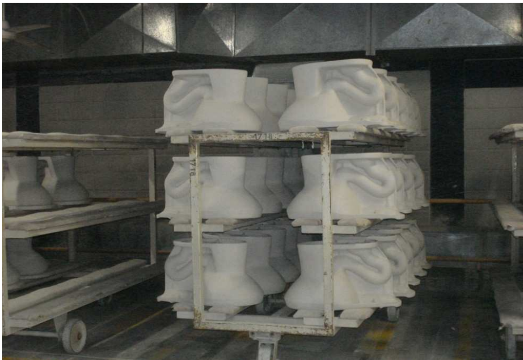
Figura 3.25. Fotografía que muestra el diseño de los coches en el área de vaciado previa la implementación de la medida de gestión del riesgo de estrés térmico (EDESA, 2011)
