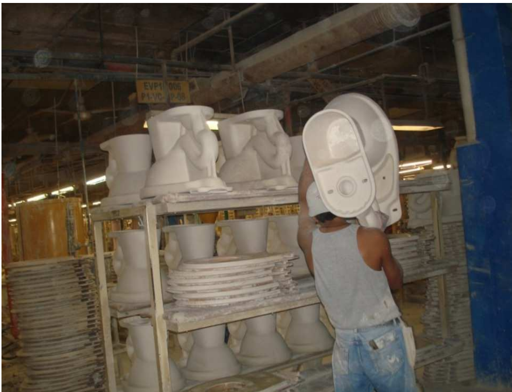
Figura 3.13. Fotografía que muestra el transporte manual de pocetas pulidas (EDESA, 2011)
