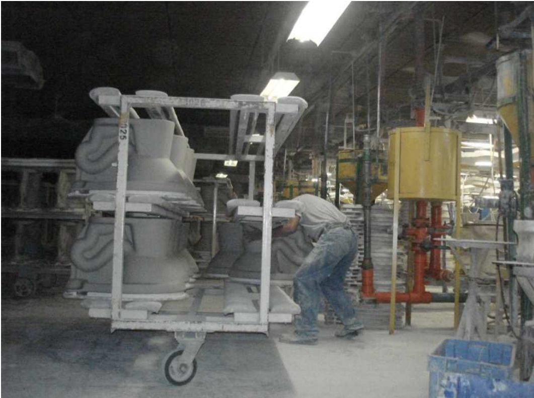
Figura 3.14. Fotografía que muestra la descarga de la poceta pulida en el coche (EDESA, 2011)
