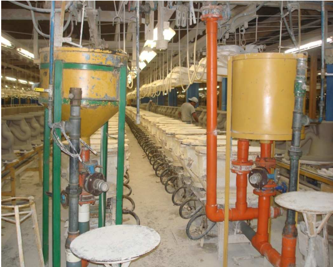
Figura 3.1. Fotografía de dos líneas de 50 moldes cada una (EDESA, 2011)
