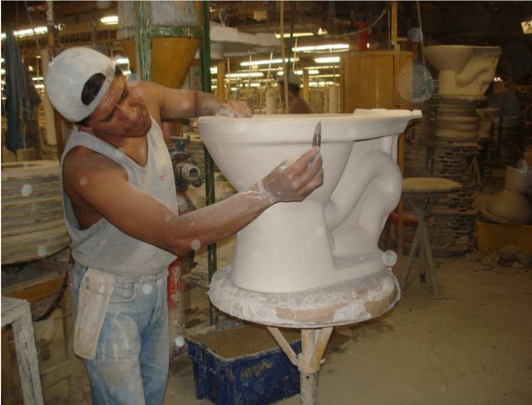
Figura 3.12. Fotografía que muestra una escena de las tareas de pulido de las pocetas (EDESA, 2011)
