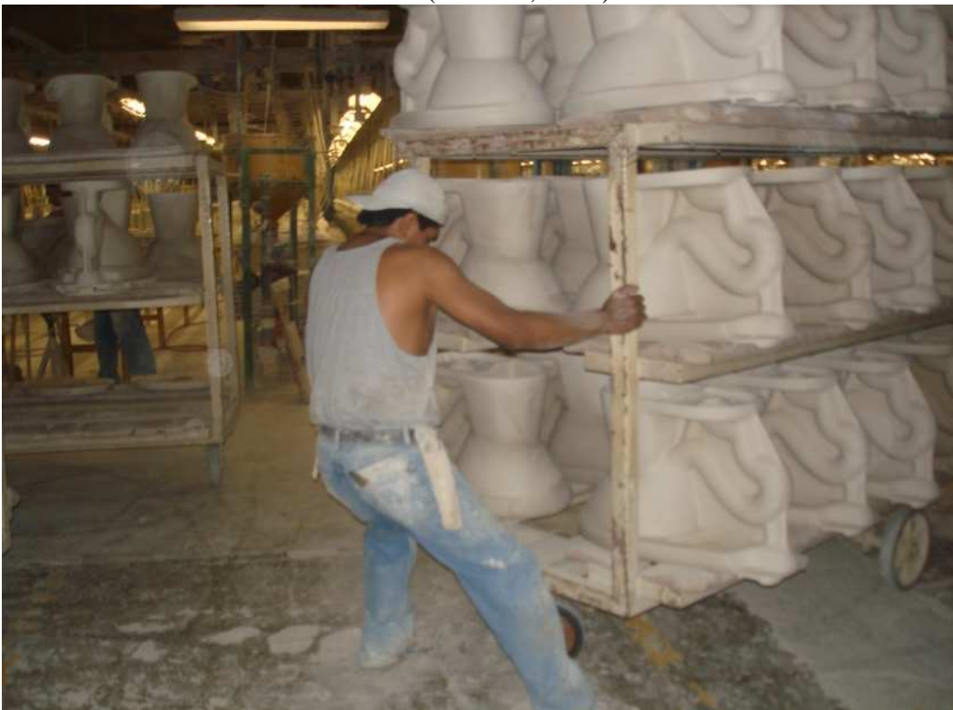
Figura 3.15. Fotografía que muestra al trabajador posicionado el coche para proceder a empujarlo hasta el área de secado al ambiente, denominada área de cuarentena (EDESA, 2011)
