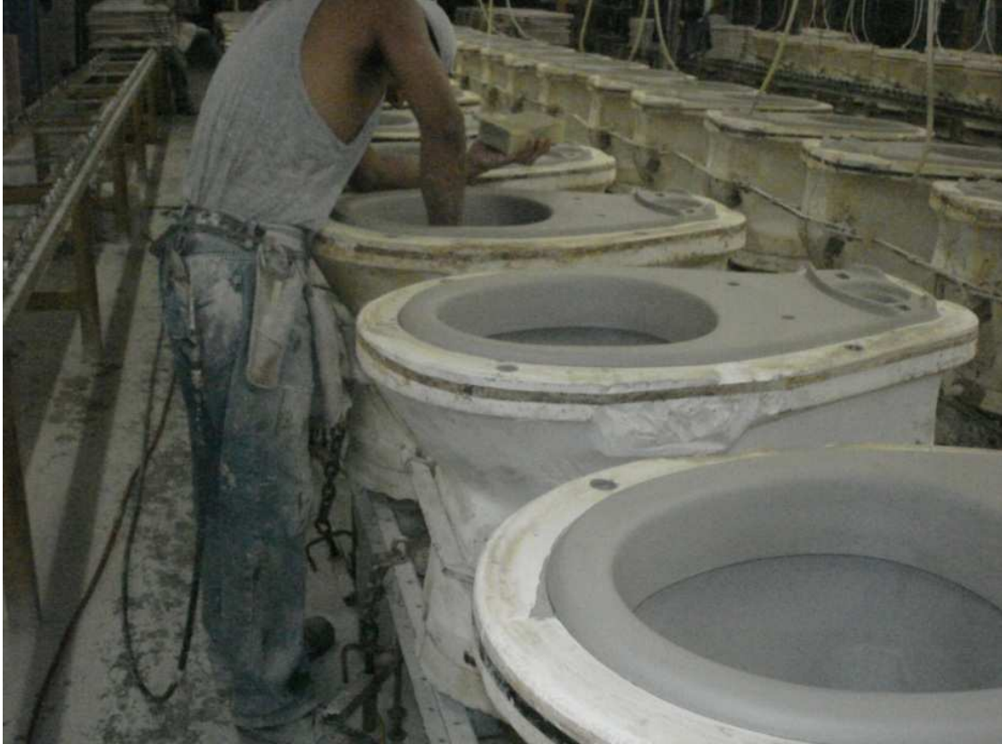
Figura 3.9. Fotografía que muestra la tarea de lavado de pozo (EDESA, 2011)
