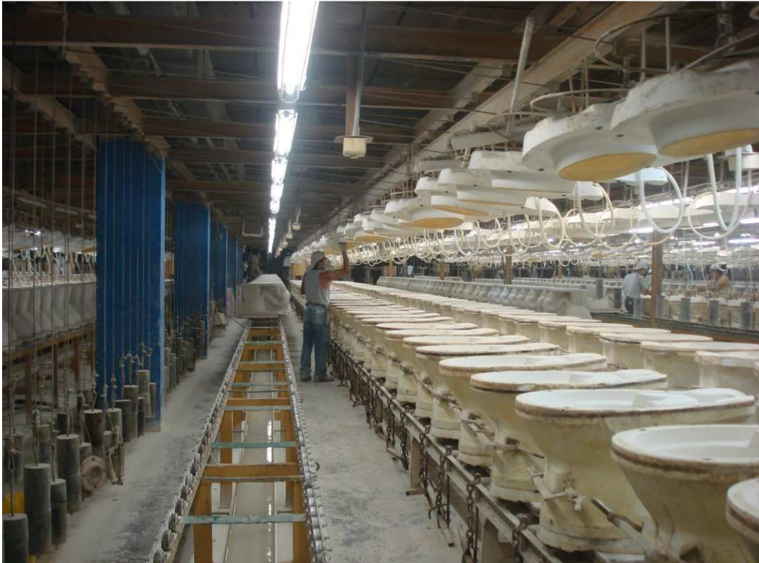
Figura 3.5. Fotografía que muestra al trabajador al realizar la actividad de aplicar vaselina al núcleo del molde del cuerpo de la poceta (EDESA, 2011)
