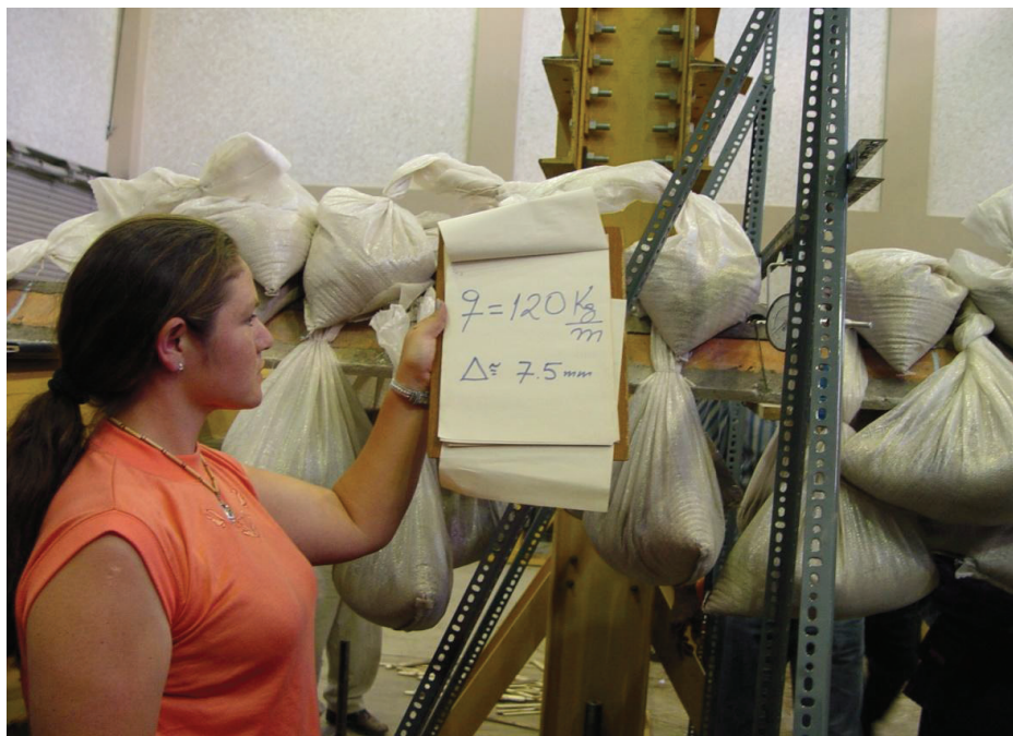
FOTO 5.5 PRUEBA DE CARGA MÓDULO BATEA TECHO, TALLER CYTED, EPN
