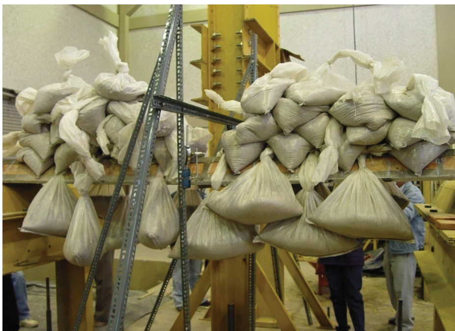
FOTO 5.6 PRUEBA DE CARGA MÓDULO BATEA TECHO. TALLER CYTED, EPN
