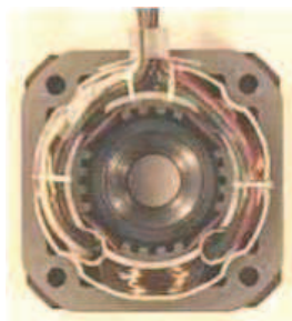
Figura 2.13. Imagen de un estator de 4 bobinas
