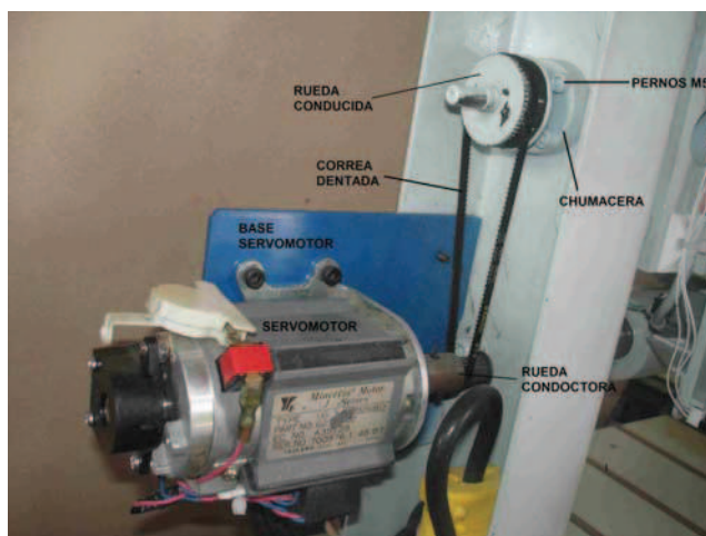
Figura 4.21 Chumacera, base, servomotor, ruedas y correa dentada.
