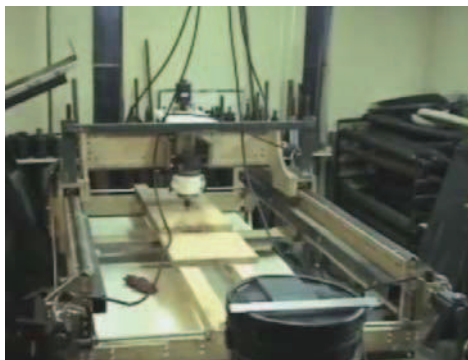
Figura 3.2. Apoyo en 2 puntos con 4 actuadores
