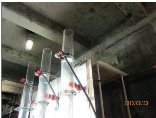
Fuente: Filtro piloto, PTAP
