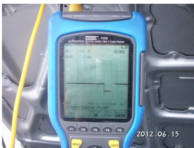
Figura 3. 14 Señal del pulso del Inyector
