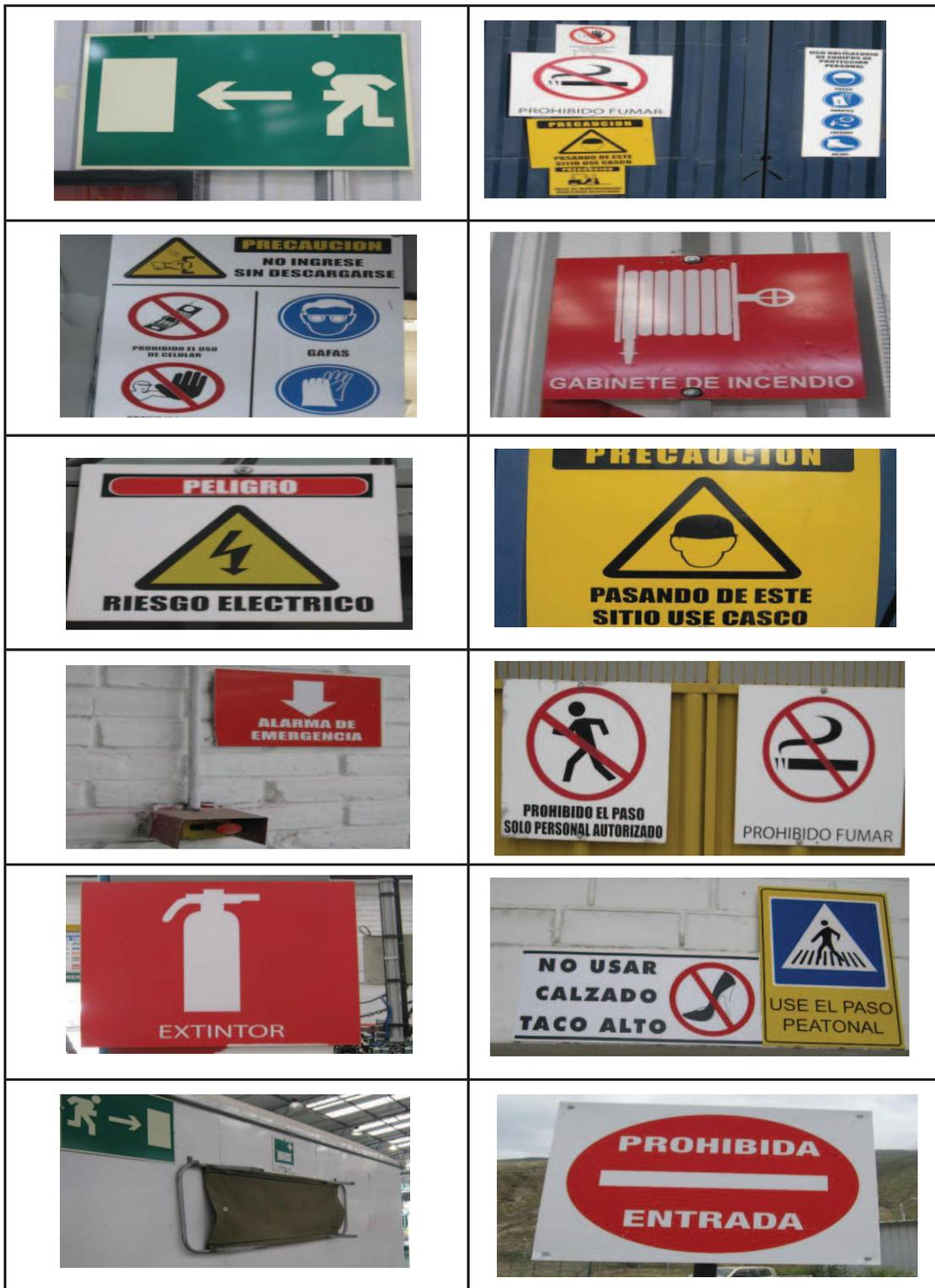
Figura 3.13 – Señalización actual en la planta industrial
