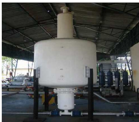
Tanque Calibrador de Medidores.
