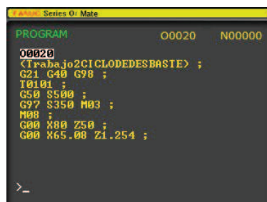
Figura 4. 36. Programa montado al controlador.
