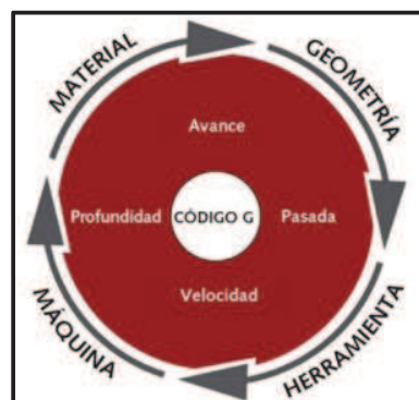
Figura 2. 16. Parámetro para generar el código G de operaciones CNC.
