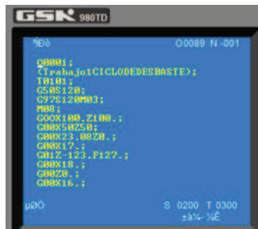
Figura 4. 48. Programa montado al controlador.
