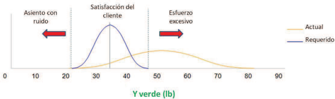
Figura 28: Distribución de esfuerzo del problema del abatible del asiento
