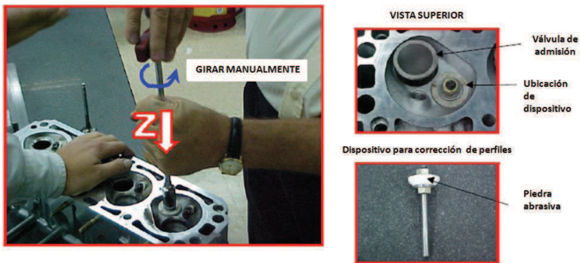
Ilustración 4: Re-trabajo de la válvula defectuosa con dispositivo de corrección
