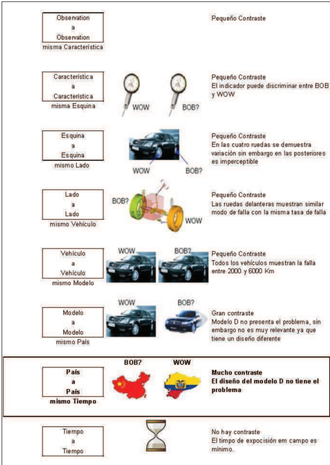
Figura 54: Diagrama de estrategia, problema de vibración en eje delantero
