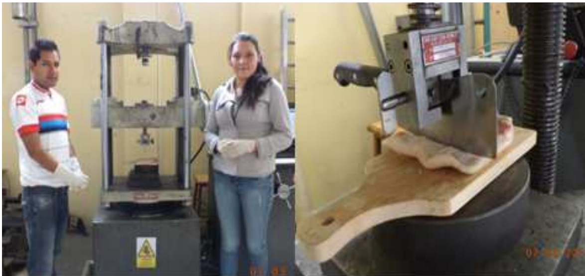
Figura 12. Ensayo de corte usando la máquina Universal TiniusOlsen
