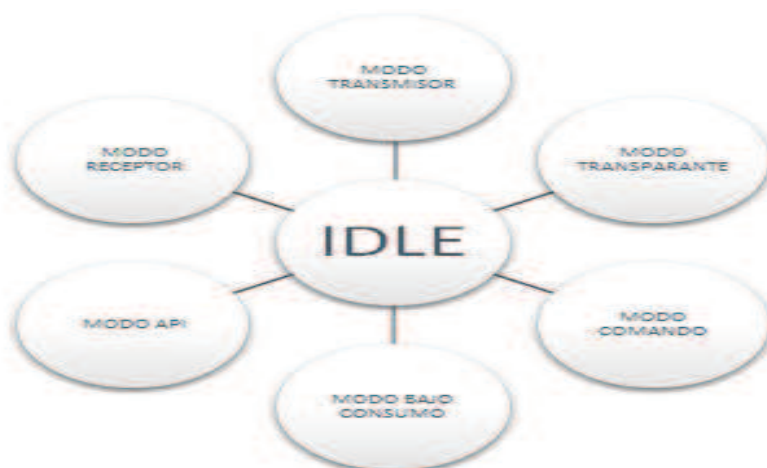
Figura 1. 3 Modos de funcionamiento del módulo Xbee
