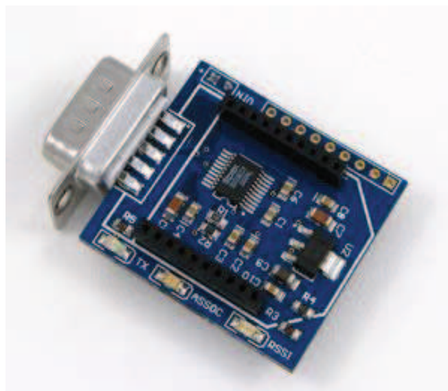
Figura 2. 28 Placa de programación de módulo Xbee del fabricante
