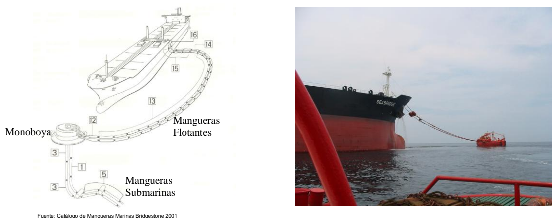
Figura No. 12 Configuración Lazy S de las monoboyas y mangueras marinas
