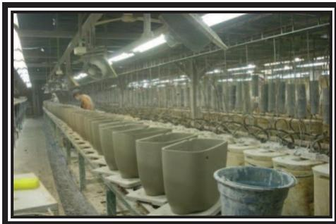
**Figura 3. 6** Proceso de vaciado
