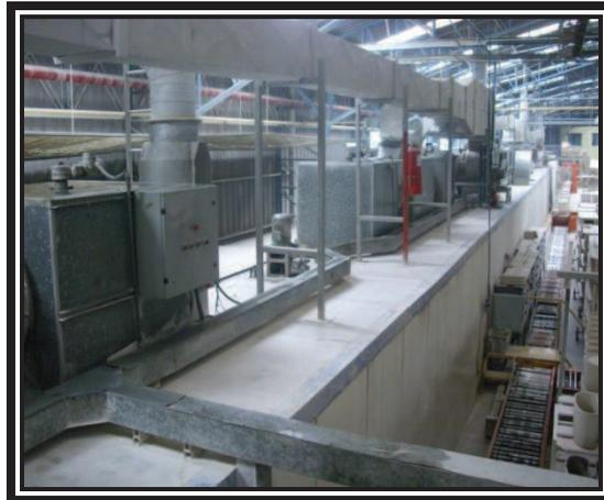
**Figura 3. 10** Túnel de secado
