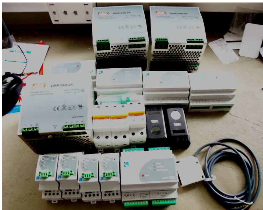
Fig. 2. 36 Equipos empleados en la instalación del Sistema De Guía Vehicular
