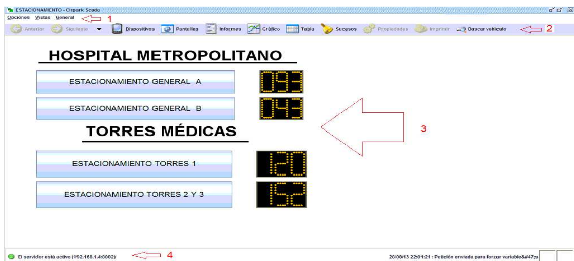
Fig. 4. 54 Pantalla Scada visualizada en el Modulo Cliente
