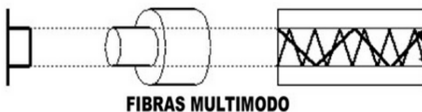
Fig. 2. 34 Representación Gráfica de una Fibra Multimodo
