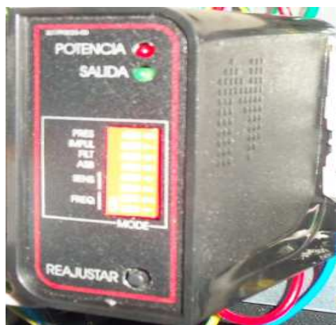
Fig. 2. 43 Detector Magnético por Lazo Inductivo
