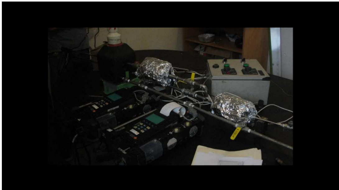
Figura 2.9. Analizadores de gases TESTO 350 XL, durante los ensayos de remoción simultánea de \text{SO}_2 y \text{NO}_x
