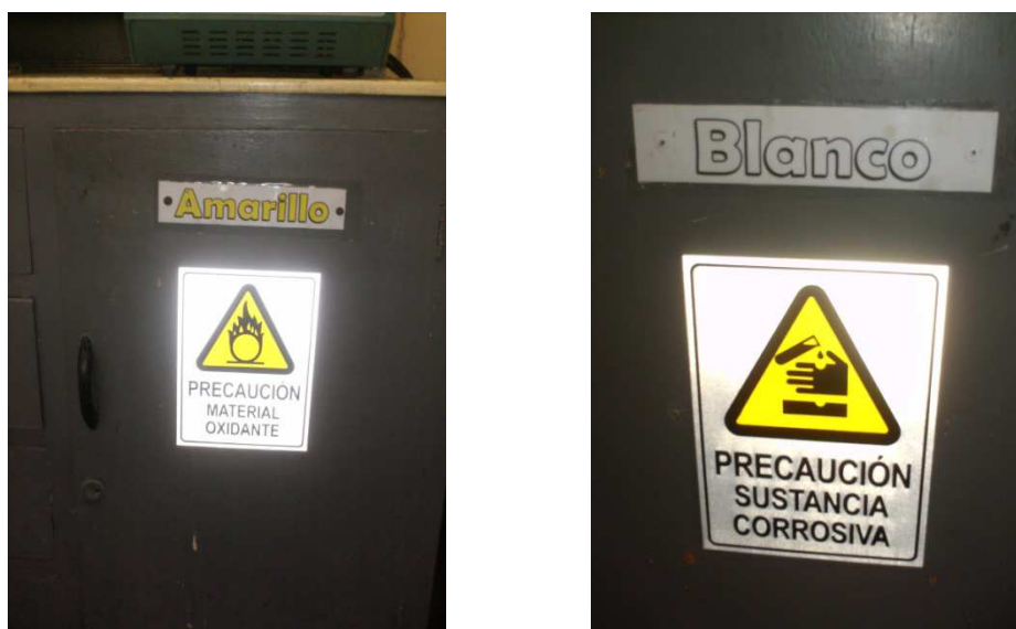
Figura 3.20. Estantes de almacenamiento de reactivos con sus pictogramas de seguridad
