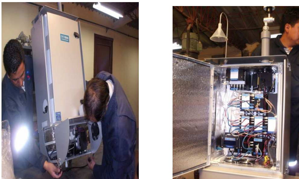
Figura 3.12. Montaje y preparación del equipo para medir PM_{2.5}
