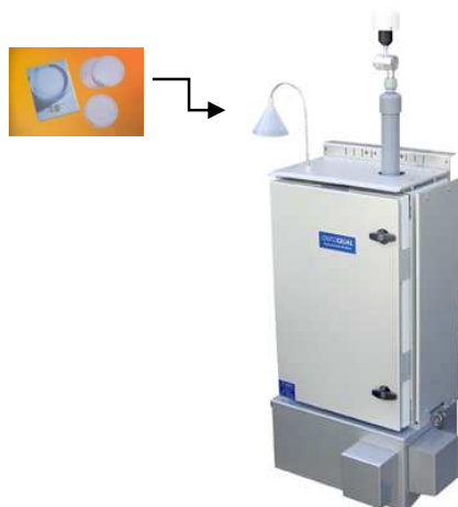
Figura 2.6. Muestreador Aeroqual AQM 60 para medir PM_{2.5} (Mora, 2010, p. 139)
