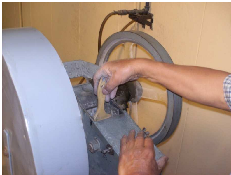
Figura 3.25. Operador ingresando objeto en la abertura de la trituradora, con su mano y brazo cerca de la polea y sin equipo de protección personal
