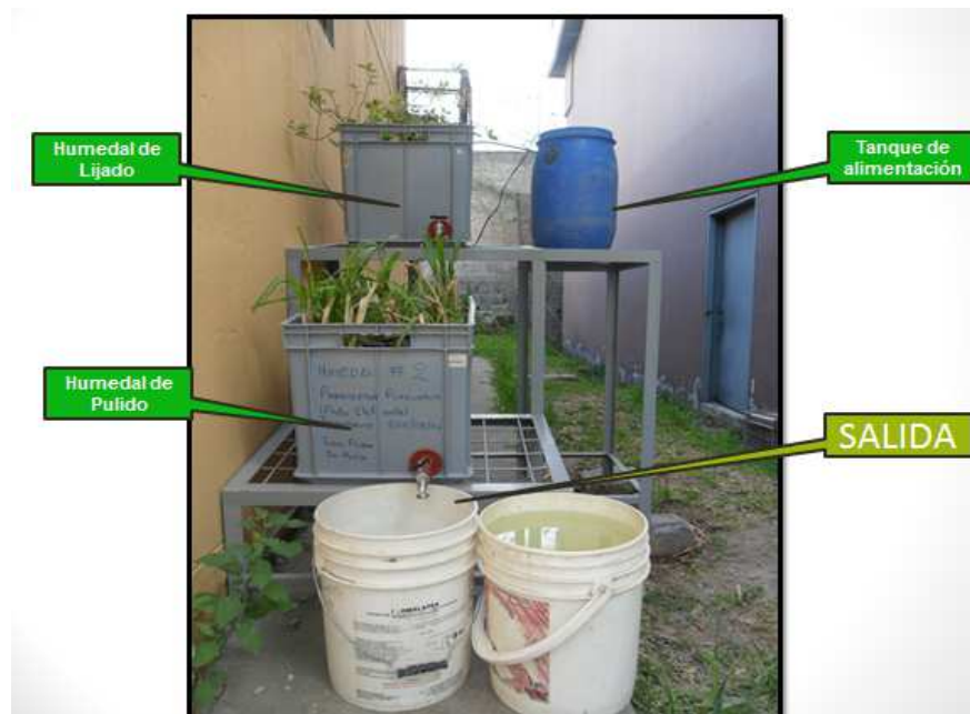
Figura 3.54. Sistema de humedales empleados para el proceso de fitorremediación (Guanoluisa, 2012, p. 90)
