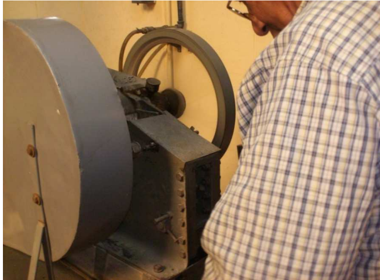
Figura 3.24. Operador con su cara en dirección hacia la abertura de ingreso de la muestra y sin equipo de protección ocular
