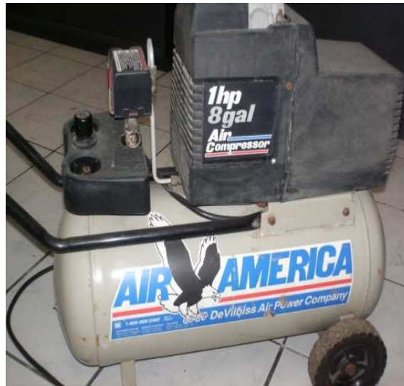
Figura 2.9. Compresor de aire seco del equipo de Absorción Atómica ubicado en la zona # 1 que necesita ser reemplazado
