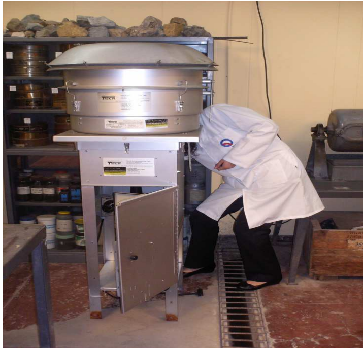
Figura 3.1. Imagen del equipo de alto volumen marca Tisch Environmental utilizado para medir PM_{10}
