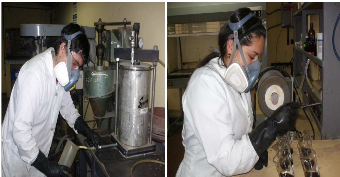
Figura 3.37. Personal utilizando como equipo de protección personal una media máscara con cartuchos para vapores ácidos y orgánicos
