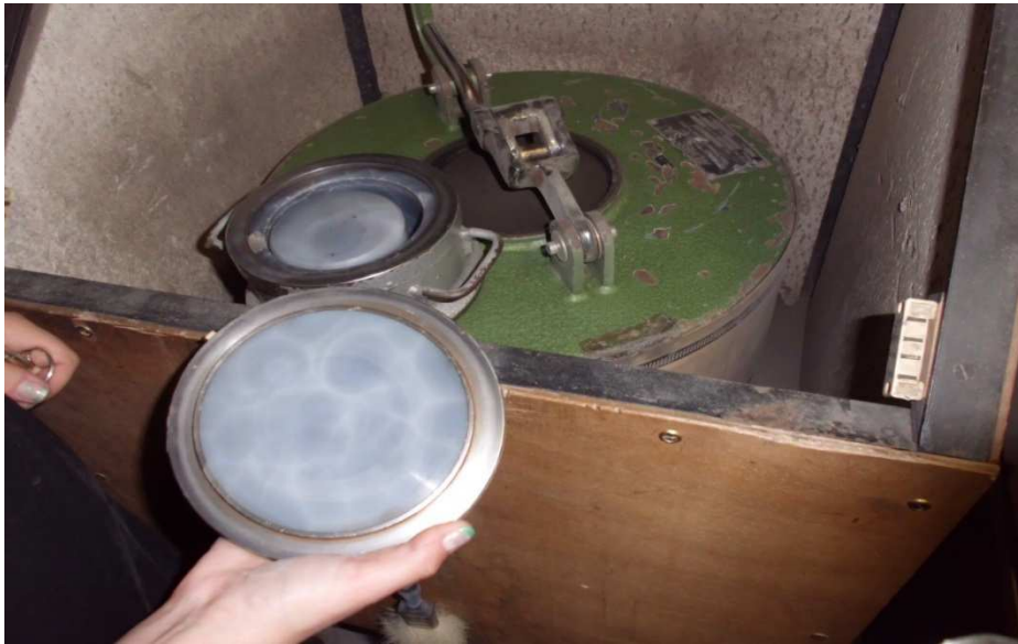
Figura 3.28. Imagen del pulverizador con su cubierta aislante para ruido
