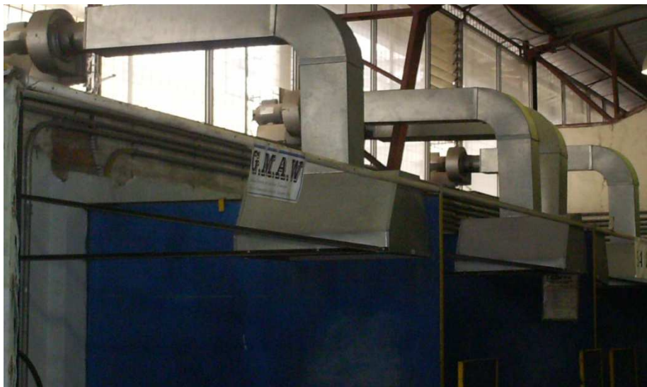
Figura 3.34. Imagen de sistema de extracción localizada que se podría colocar sobre las trituradoras primaria, secundaria y el molino de rodillos
