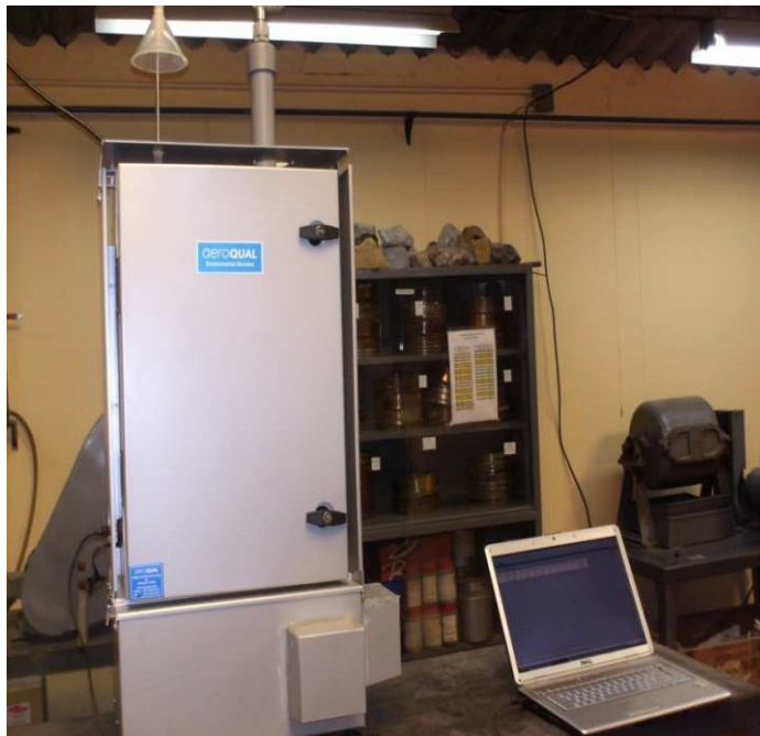
Figura 3.2. Imagen del equipo AQM60 utilizado para medir PM_{2.5}
