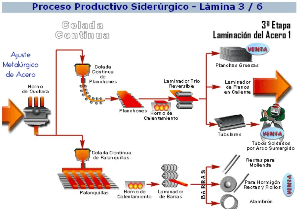
**IMAGEN 10: PROCESO DE LAMINACIÓN DE PLANCHAS DELGADAS PARA APLICACIONES INDUSTRIALES**
