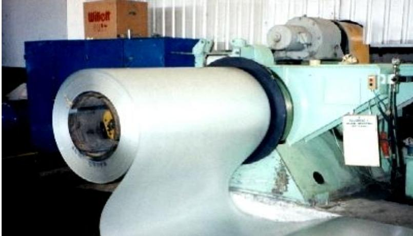
Dependiendo de los pedidos realizados por el área comercial, se selecciona la materia prima adecuada para colocar las bobinas en la línea de conformación (rollformer)<sup>32</sup> y elaborar los paneles metálicos o perfiles galvanizados.
