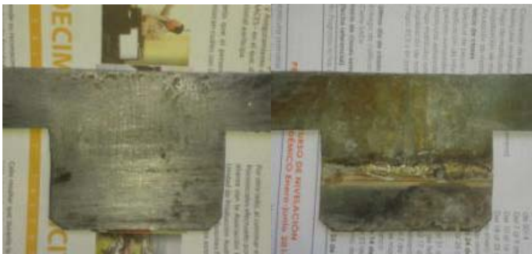
Figura 3.13. Ánodo de plomo antes y después del proceso de recuperación por electrolisis
