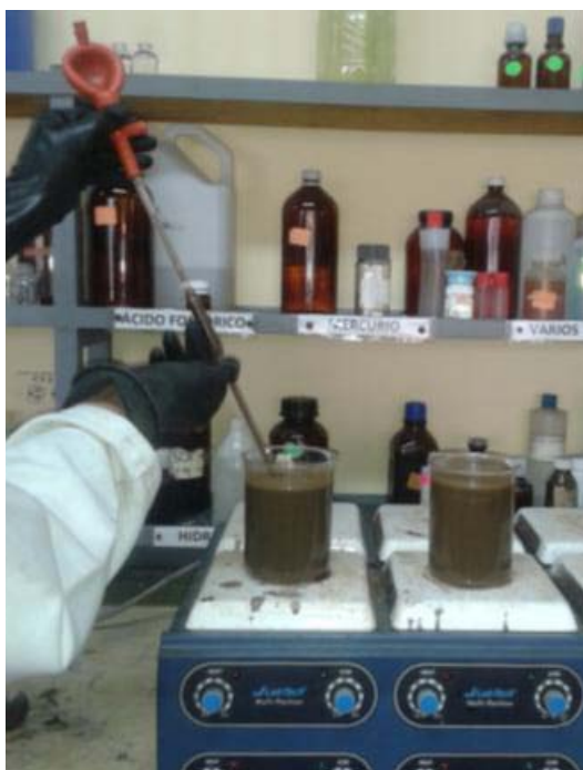
Figura 2.3. Esquema de cómo realizar los ensayos en la cinética de lixiviación con soluciones paralelas
