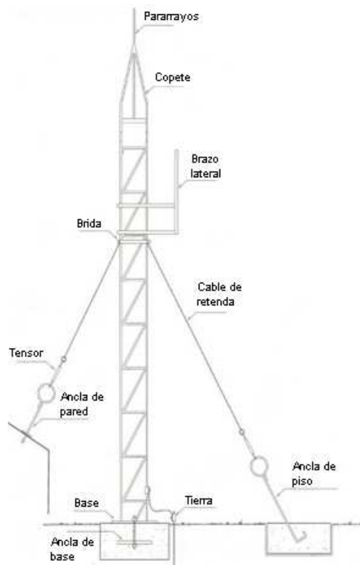
Fig. 3.2 Estructura de una torre de comunicaciones venteadada
