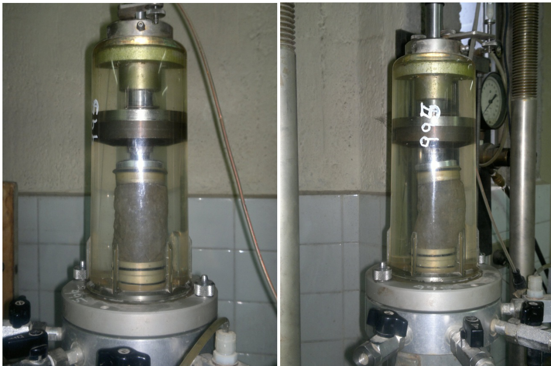
FOTOGRAFÍA 3.13a y 3.13b.- Ensayo triaxial al inicio y al final.
