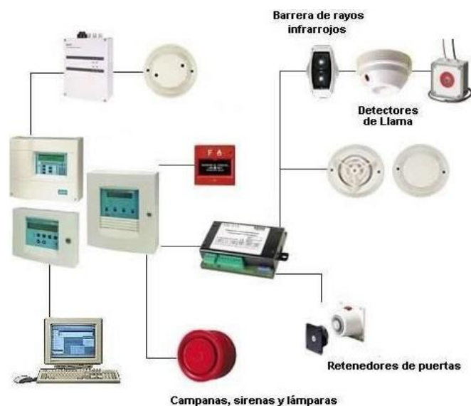
Figura 1.6 Distribución de un sistema de detección inteligente [5]
