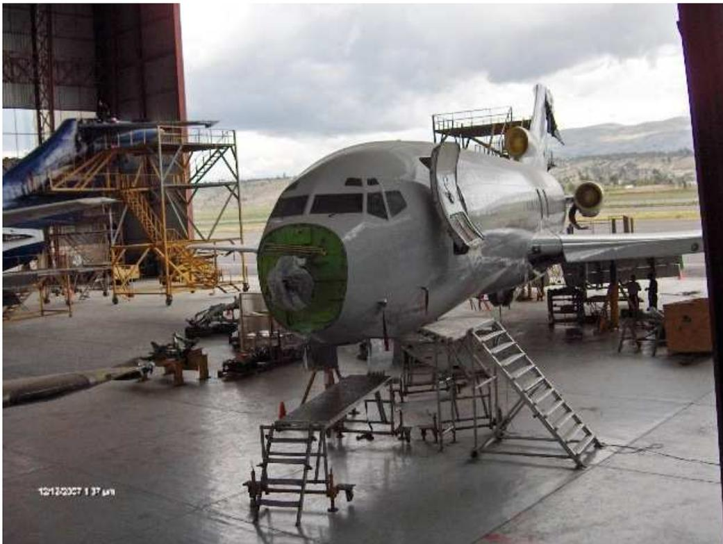
La instalación principal de la organización es el hangar en Latacunga, construido con estructura metálica, con tejado metálico; tiene 65 m longitud por 60 m de ancho y 24 m de altura, con un área de 3900 m<sup>2</sup>, con capacidad para el mantenimiento de un avión DC-10 y un avión Boeing 737-200 simultáneamente o cuatro aviones Boeing 737-200 al mismo tiempo, el piso es de hormigón
