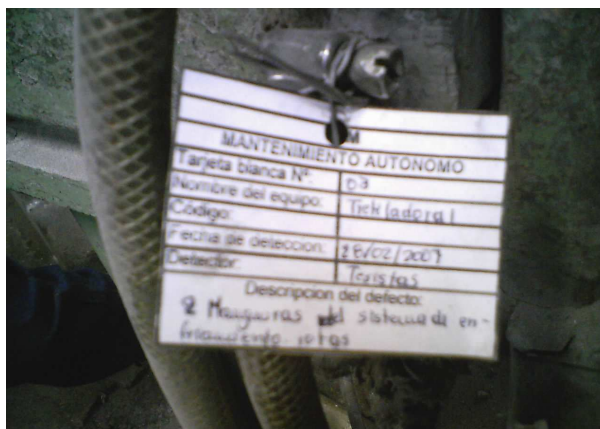
Figura 3.15 Ubicación de las tarjetas de defectos en los equipos de Trefilec
