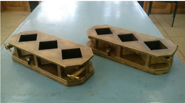
Fotografía 6.- Moldes metálicos de 50mm de arista para especímenes
