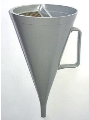
Fotografía 3.- Equipo Para Medición de Viscosidad (Cono Marsh)
