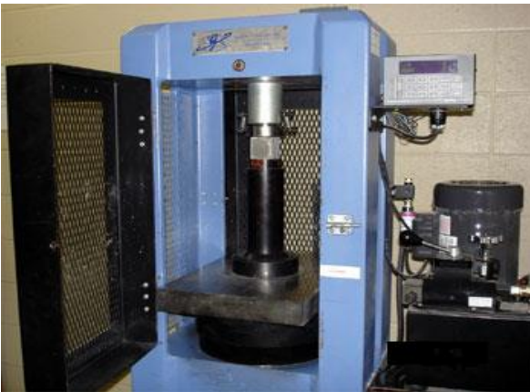
Fotografía 7.- Máquina de ensayo de compresión adaptada para especímenes de arista 50mm
