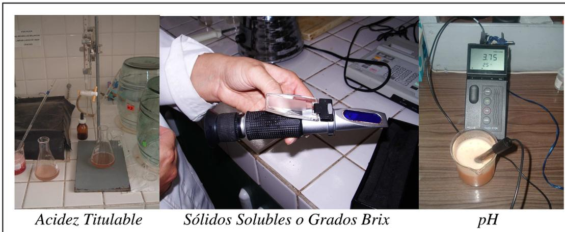
**Figura 6. Métodos químicos para la determinación del índice de madurez**
