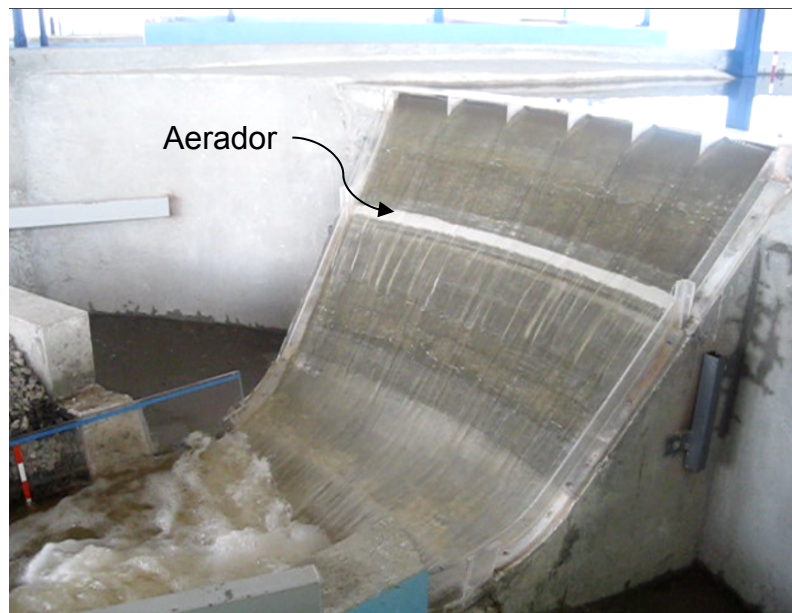
Foto 1.5: Aerador en modelo hidráulico del vertedero de la presa "Zapotillo" (México)
