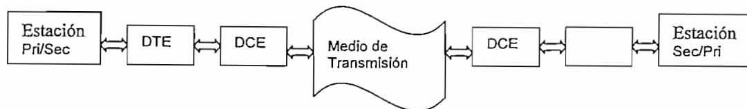
Figura 1.1.- Elementos de la Transmisión de Datos.
