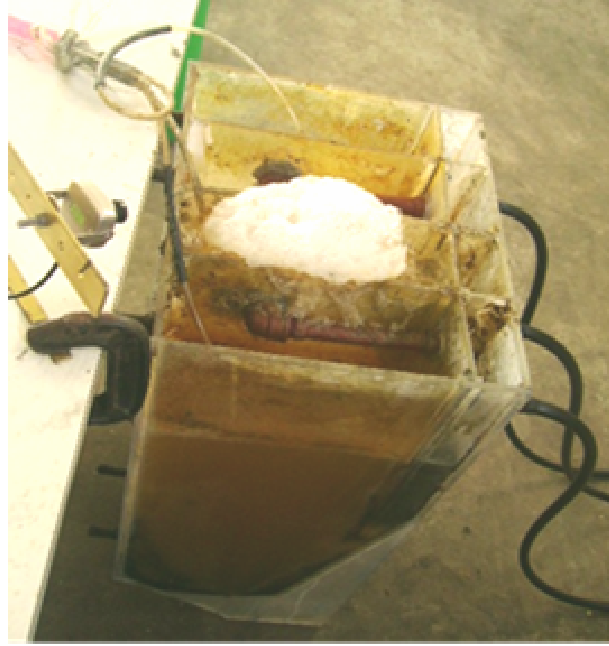
Figura 3.26 Cámara y reactor biológico
