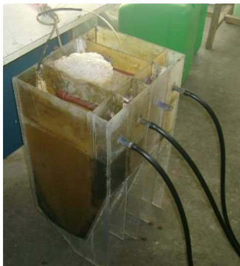
Figura 3.12 Reactor biológico funcionando
