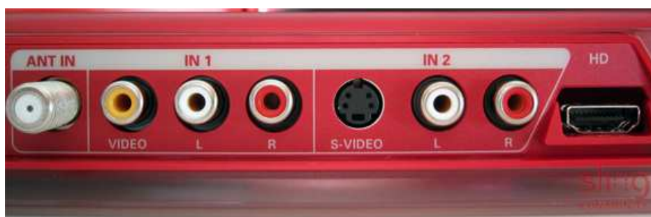
Figura 3.15 Vista posterior del equipo SLINGMEDIA, entradas de video analógico
