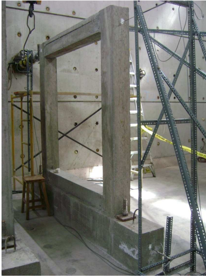
Figura 4.14a. LVDTs en el pórtico PSVEW.
