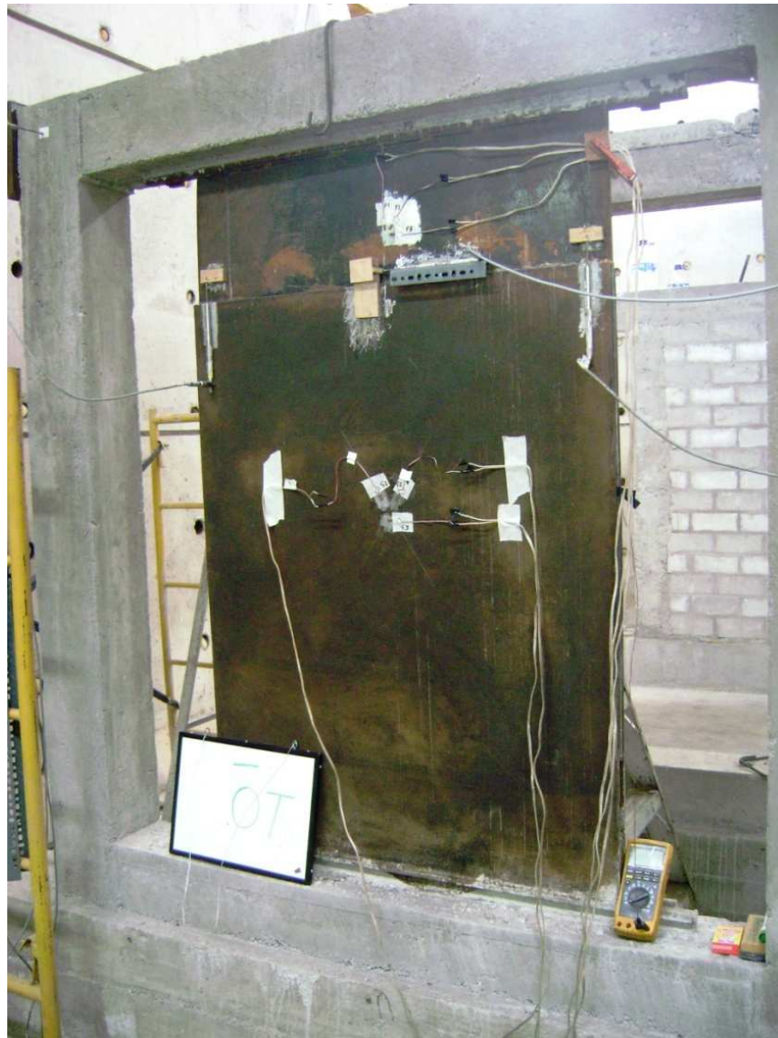
Figura 4.22. Instrumentación del muro viscoelástico.
