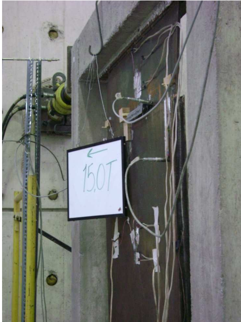
Figura 4.27g. Indicio de pandeo en el VEW. Carga -15.0Ton.
