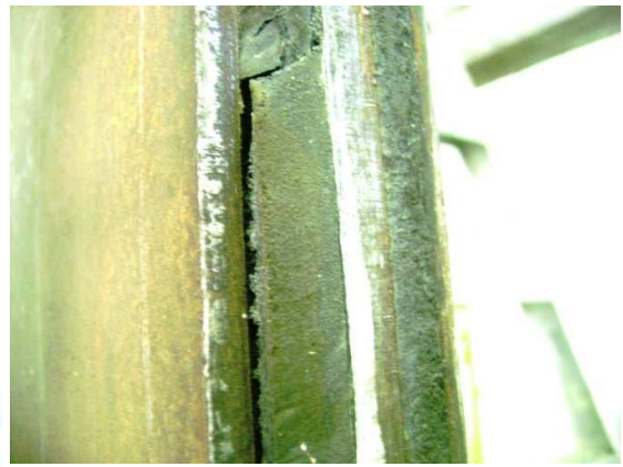
Figura 4.27h. Desplazamiento relativo entre placas del VEW. Extremo derecho. Carga 15.0Ton.
