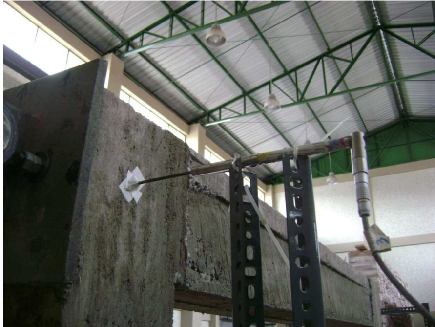
Figura 4.14b. LVDT en frente izquierdo.
