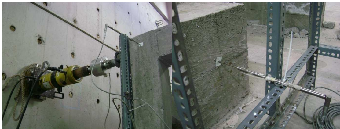
Figura 4.18a. Actuador dinámico y LVDTs en pórtico PVEW.
