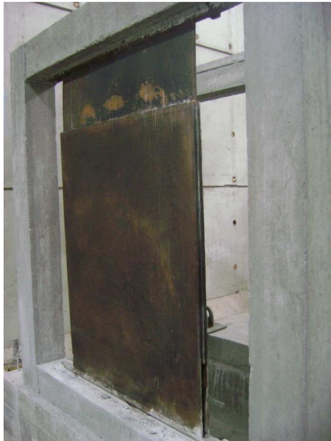
Figura 4.12d. Muro viscoelástico en el pórtico PVEW.
