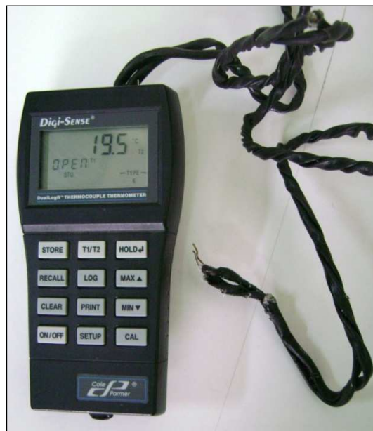
Figura 3.8. Termocupla utilizada en fase experimental I.
