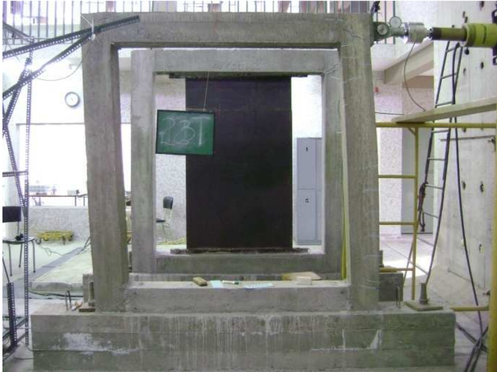
Figura 4.25a. Inicio Sub-Fase 2. Desplazamiento +70.0mm
