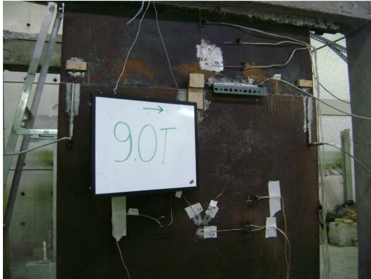
Figura 4.27b. Etapa en que se retiran LVDTs laterales del VEW. Carga 9.0Ton.
