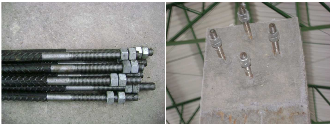
Figura 4.9. Varillas de acero para anclaje con gato hidráulico
