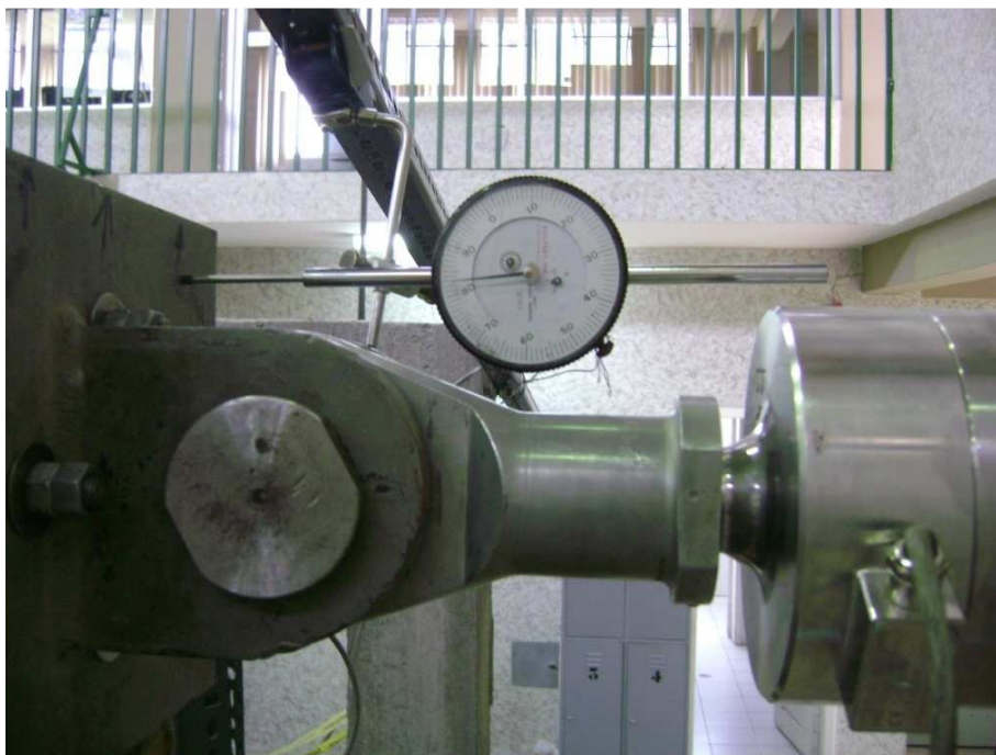
Figura 4.15. Deformímetro para control manual de desplazamientos.
