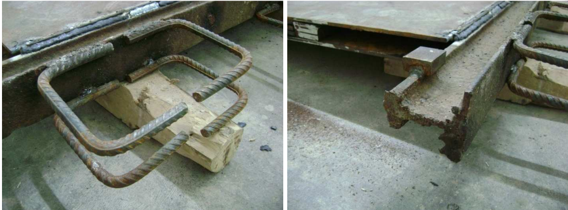
Figura 4.2b. Muro viscoelástico. Detalles de anclaje y conexión
