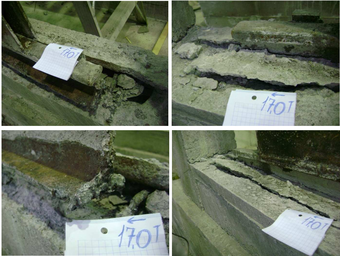
Figura 4.27l. Falla unión VEW – Cadena inferior. Carga -17.0Ton.
