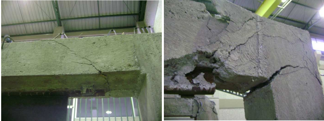
Figura 4.27n. Nudos superiores izquierdo y derecho. Carga -17.0Ton.
