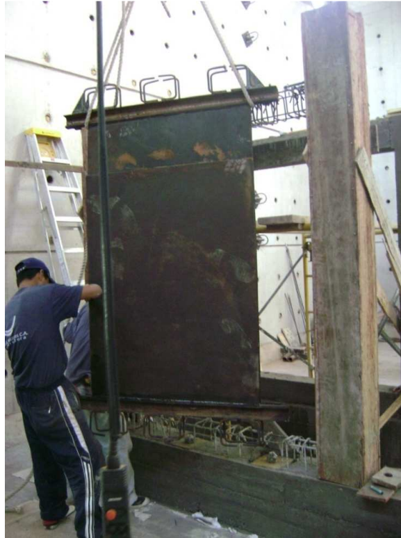
Figura 4.10. Ubicación del muro viscoelástico en el pórtico PVEW.
