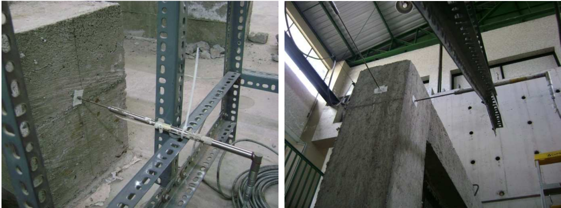
Figura 4.18b. LVDTs en pórtico PVEW.
