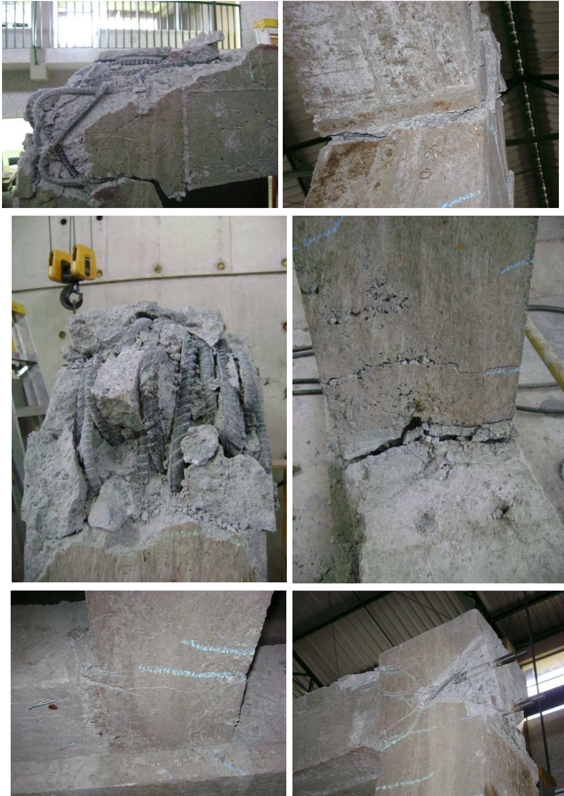
Figura 4.26. Estado Final del pórtico PSVEW.
