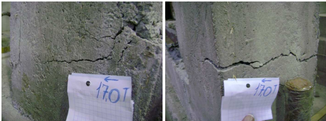
Figura 4.27m. Nudos inferiores izquierdo y derecho. Carga -17.0Ton.
