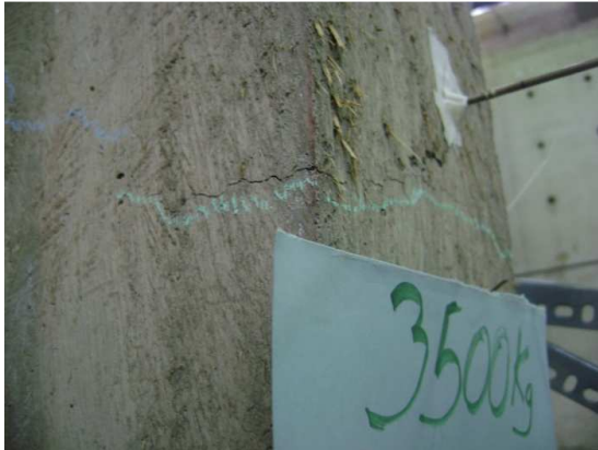
Figura 4.24e. Carga final +3.50Ton.
