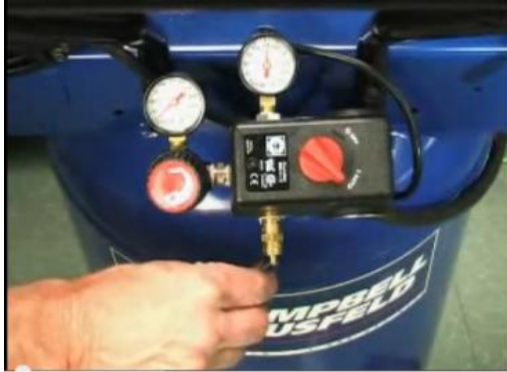
Figura 3.11: Válvula de seguridad del compresor.
