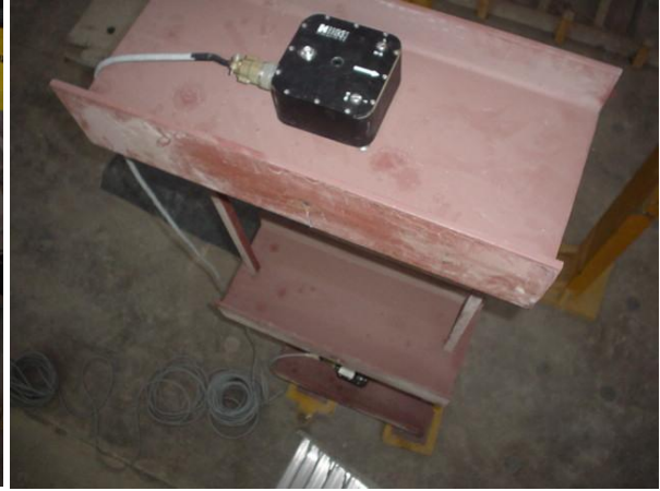
Foto 5.3.2. FBA-23 en tercer nivel y primer nivel.
