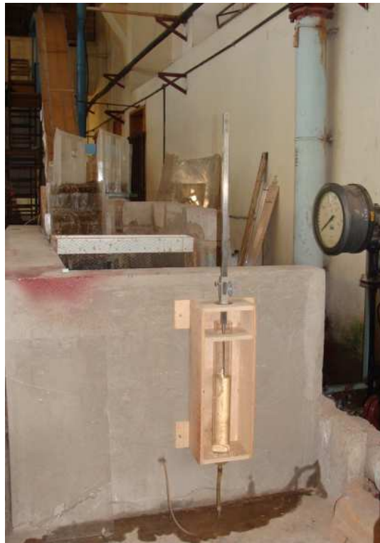
Fotografía No. 4.3: Sistema piezométrico, para la determinación de Caudales (EPN-EMAAPQ/2000)
