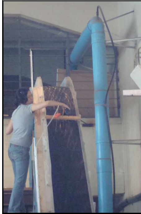
Fotografía No. 7.19: Registro de datos con caudal en el modelo de Q_4 = 7 \text{ lt/s}
