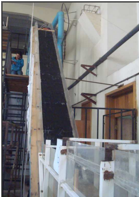
Fotografía No. 7.17: Rápida con el caudal en el modelo de Q_3 = 3 \text{ lt/s}
