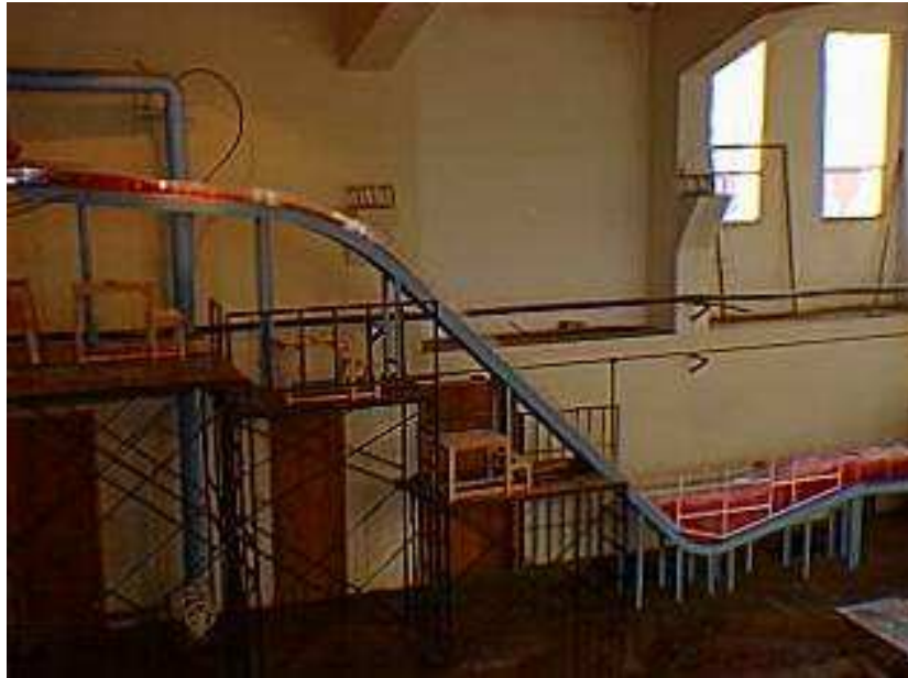
Fotografía No. 4.1: Rápida de Descarga Modelo Quebrada Batán
