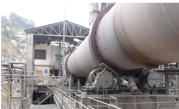
**Figura 2** – Horno de cemento
