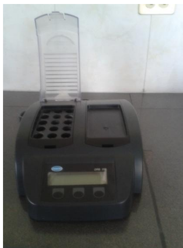
EQUIPO DIGESTOR DQO
