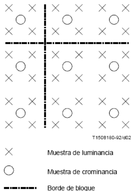
Figura 2.6 Posición de las muestras de luminancia y crominancia en 4:2:2 13
