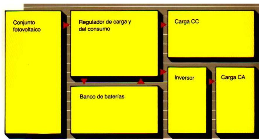
**Figura 5.8. Diagrama de una configuración fotovoltaica típica** <sup>[5.1]</sup>
