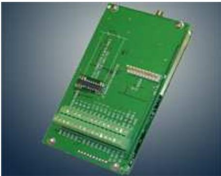
**Figura 3.9 Radios con terminales I/O** <sup>[3.3]</sup>
