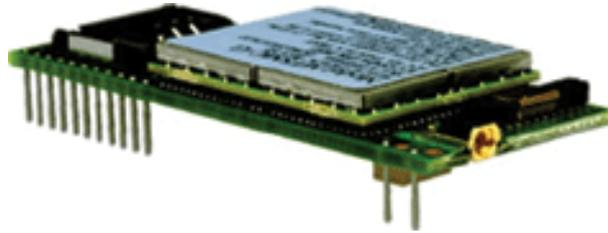
**Figura 3.15 Tarjeta de Adquisición y envío de Datos a través de GSM/GPRS <sup>[3.5]</sup>**
