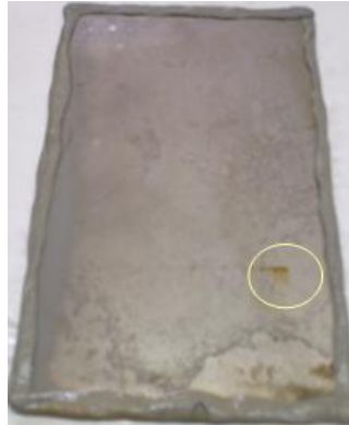
Figura 4.23. Placa P6 con 4% de polvo cerámico al cabo de 7 días de Inmersión en solución salina .
