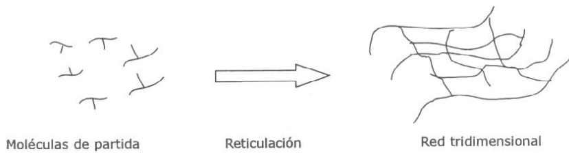
Figura 2.2. Etapas de formación de un polímero termoestable [16].
