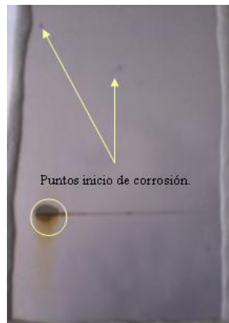
Figura 4.19. Placa P4 a los 22 días de la inmersión en la solución salina.
