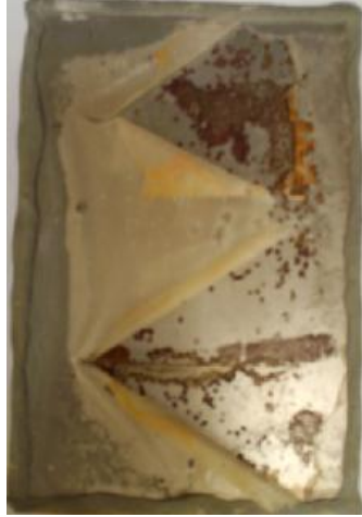
Figura 4.25. Delaminación de la placa P6, 18 días después de la inmersión.
