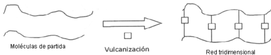
Figura 2.3. Etapas de formación de un elastómero [16].
